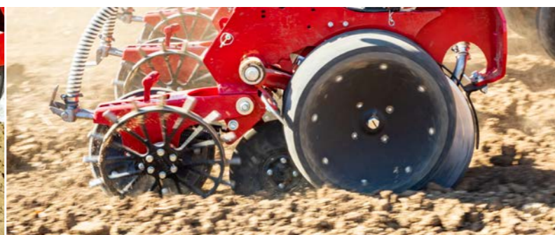
Ruote della guida di profondità con raschietto, rulli di compressione regolabili e rullo di intercettazione che nel CV può essere rimosso in condizioni molto umide.
