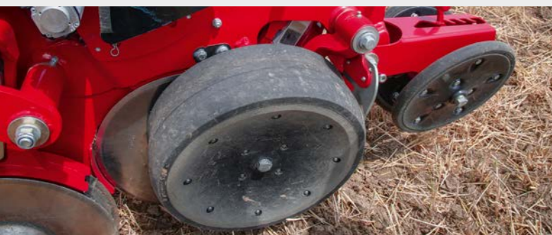
Sensore di pressione AutoForce: il peso viene rilevato tramite tecnologia piezoelettrica (trasduttore di misura della pressione).
