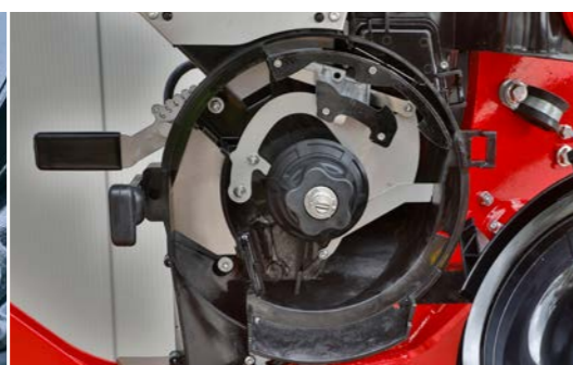
Il singolarizzatore universale non deve essere più regolato.
