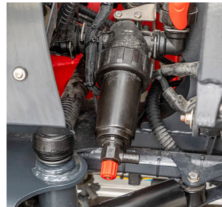
Zweiter Druckfilter im Mittelrahmen des Gestänges
