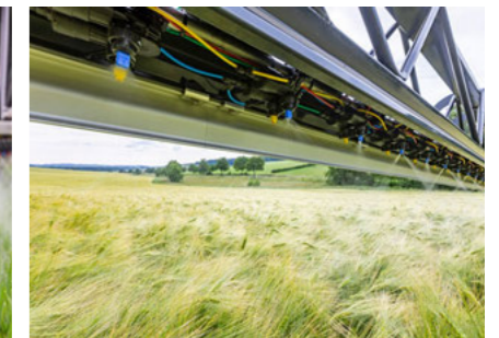
Pneumatische Düsen- und Teilbreitenschaltung
