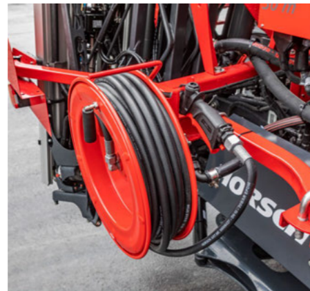
Schlauchtrommel zur Außenreinigung
