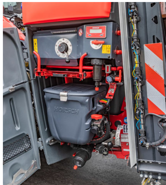
Manuelle Mehrweghähne zur Einstellung der Saug- und Druckseite
