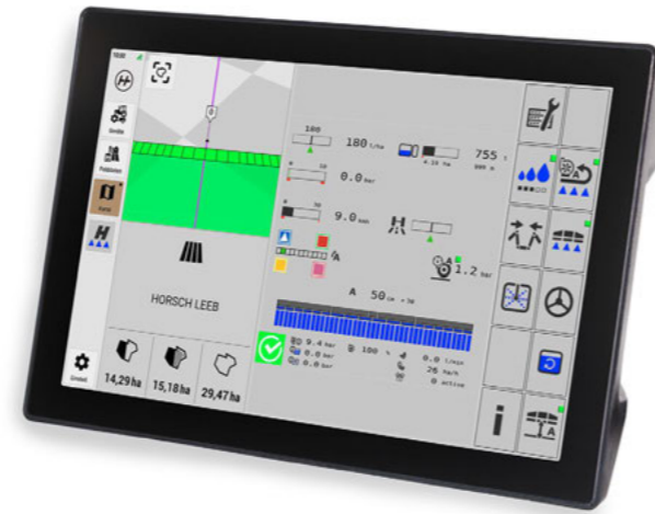
Durch die Anzeige von bis zu 3 Widgets neben dem Hauptarbeitsbildschirm können mehrere Anwendungen gleichzeitig im Blick behalten werden
