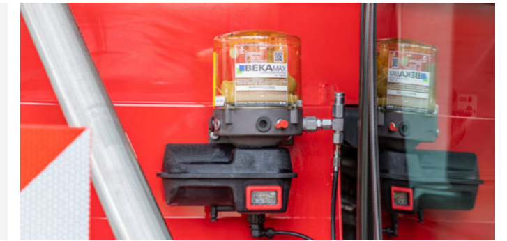
Behälter der Zentralschmieranlage
