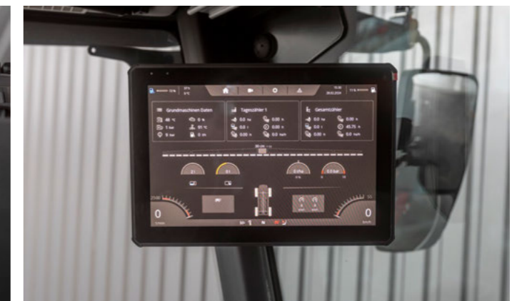
Serienmäßiges 12" A-Säulen-Display mit frei belegbarer Anzeige
