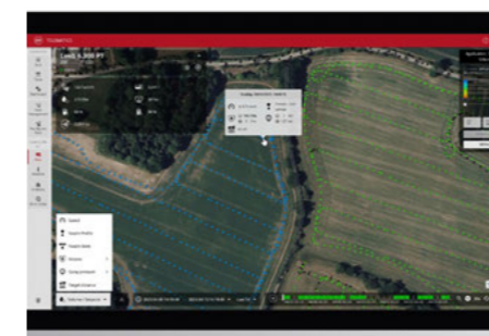
Erfolgsfaktor Transparenz: positionsbezogene Daten aller relevanten Informationen wie Fehlermeldungen, Ausbringungsmenge, Düsenstatus oder Zielflächenabstand
