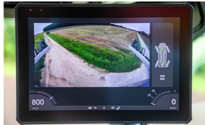
Hochauflösende, automatische Darstellung der Rückfahrkamera im A-Säulendisplay
