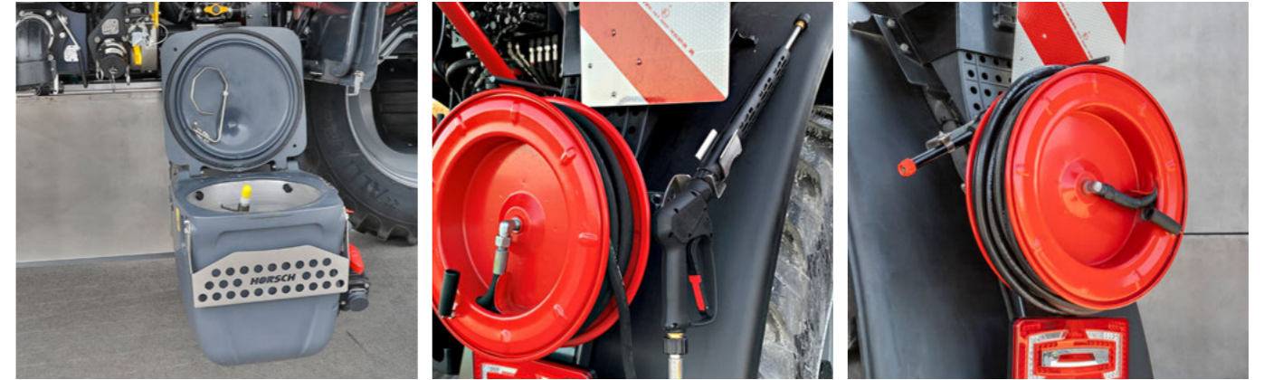
52 l Edelstahl Einspülseleuse inkl. zusätzlicher Stoßdüse
