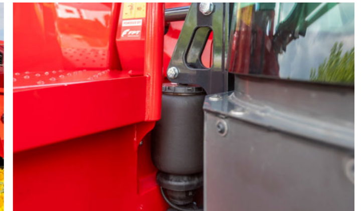
Pneumatische 4-Punkt Kabinenfederung
