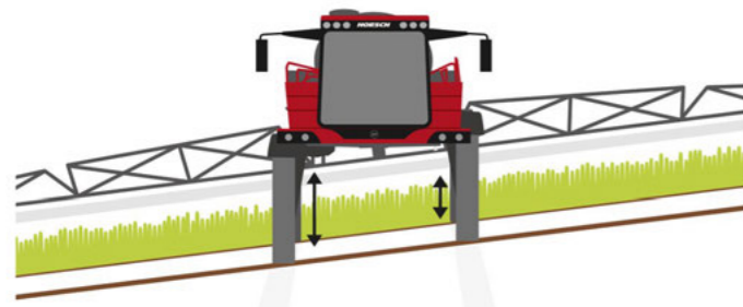
HillControl Pro reguliert zusätzlich die Bodenfreiheit stufenlos und individuell für jede Seite, um das Chassis immer waagrecht zu halten
