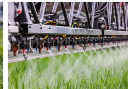
25 cm Düsenteilung: mehr Düsen mehr Möglichkeiten z.B. 3D Applikation
