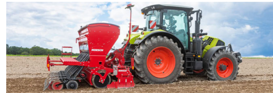
Nadstawka na zbiornik pozwala uzyskać pojemność 1.500 l
