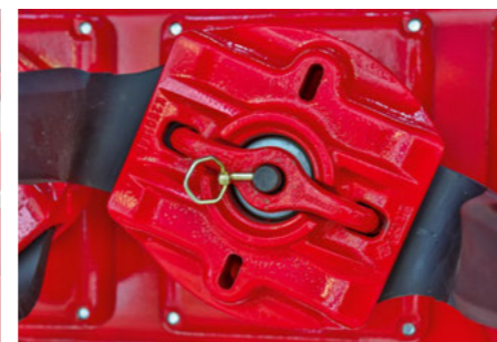
Beznarzędziowa wymiana zębów
