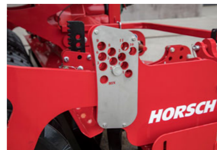
Beznarzędziowe ustawienie głębokości roboczej poprzez układ otworów pomiędzy Kredo a wałem
