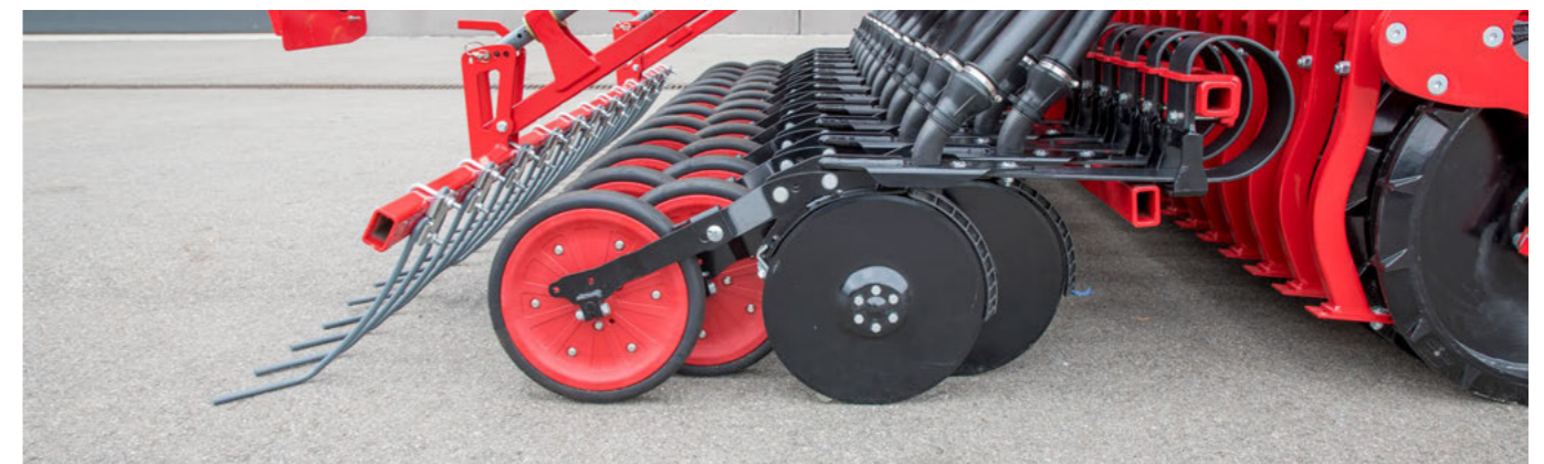
Redlica siewna DuoDisc z ciężkim zgrzeblem
