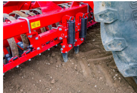
Sprężynujące zęby do spulchniania śladu
