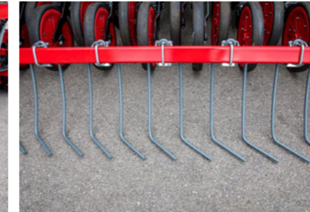
Zgrzebło z wygiętymi zębami powoduje poprzeczny ruch gleby i przykrywa pewnie każde ziarno
