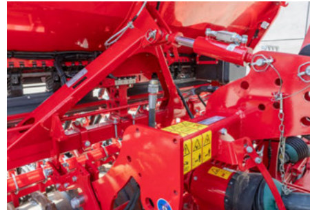
Hydrauliczne ciągiła górne pomiędzy broną wirnikową a maszyną Versa KR
