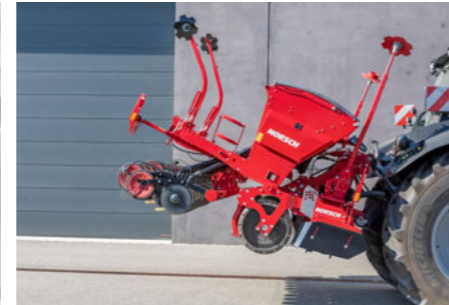
Większy prześwit do transportu drogowego dzięki wsunięciu siłownika hydraulicznego
