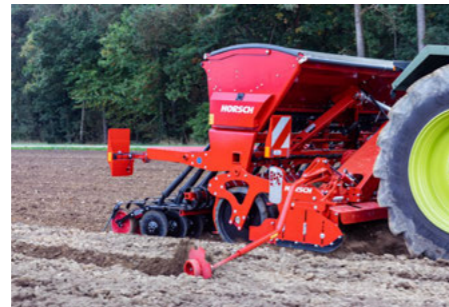
Wał pośredni jest podzielony, tak że silnik napędowy steruje każdą połówką maszyny oddzielnie
