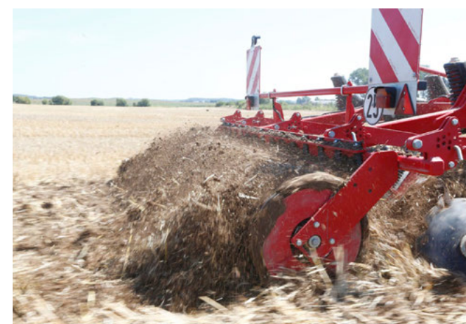
Produkcja dużej ilości drobnogrzełkowatej gleby dzięki wałom zapewnia optymalne warunki kiełkowania
