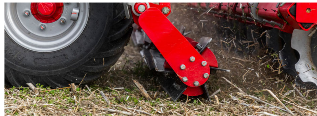
Przedni wał nożowy zapewnia idealne rozdrabnianie gleby
