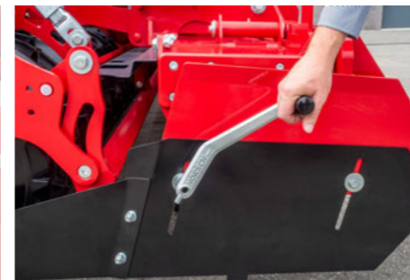
Az oldalsó pajzsok beállítása az univerzális kulccsal
