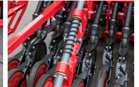
Egyszerű nehézsereblye nyomásbeállítás
