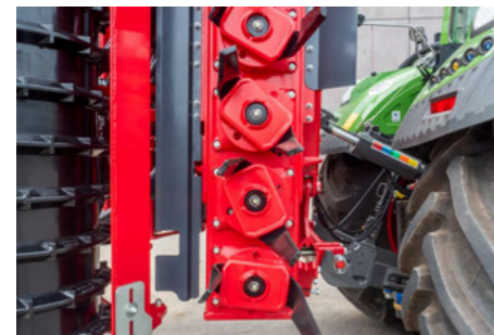
Szerszám nélküli kapacsere
