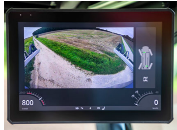
Nagyfelbontású, automatikus tolatókamerakép megjelenítés az A-oszlop kijelzőjén
