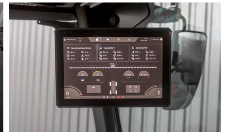
Szériafelszereltségű 12"-os A-oszlop kijelző szabadon konfigurálható megjelenítéssel
