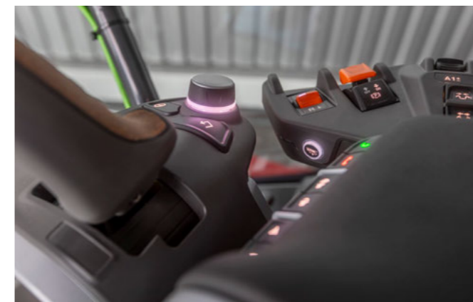
Biztonságos kezelés az A-oszlop kijelzőjén: Forgó-nyomógombokkal
