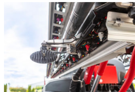
Kamera a fűvókák felügyeletéhez a NightLight tartón
