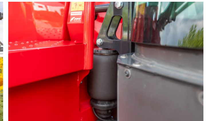
Pneumatikus 4-pontos kabinrugózás
