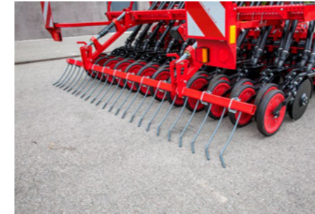
Herse lourde : idéale pour les semis tardifs dans des conditions humides
