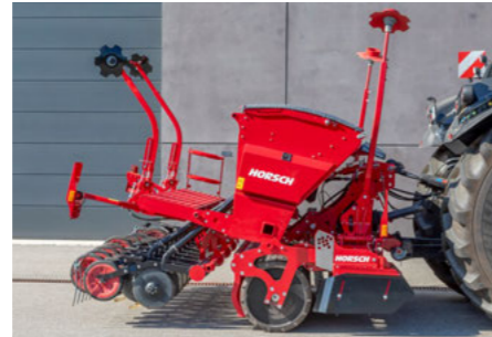
Travail de la herse rotative en tournière ou dans les coins du champ avec rampe de semis escamotée.
