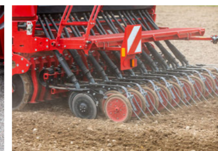
Eléments semeurs DuoDisc avec herse droite
