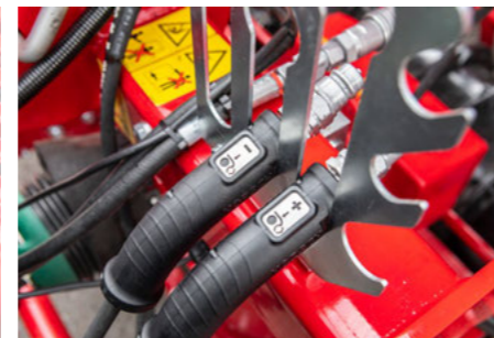
Prises hydrauliques clairement identifiées
