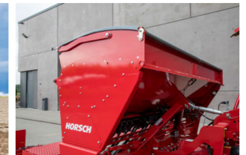
Réhausse de trémie de 1 500 l : volume de trémie accru pour des arrêts de remplissage moins fréquents
