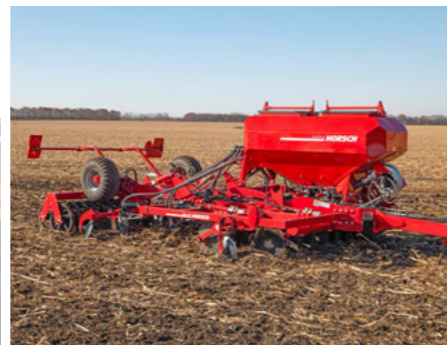
Ефективне використання добрив завдяки внесенню як депо на глибину
