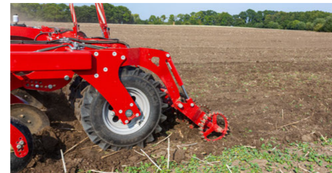
Коток TopRing для ефективного ущільнення між колесами колісного котка
