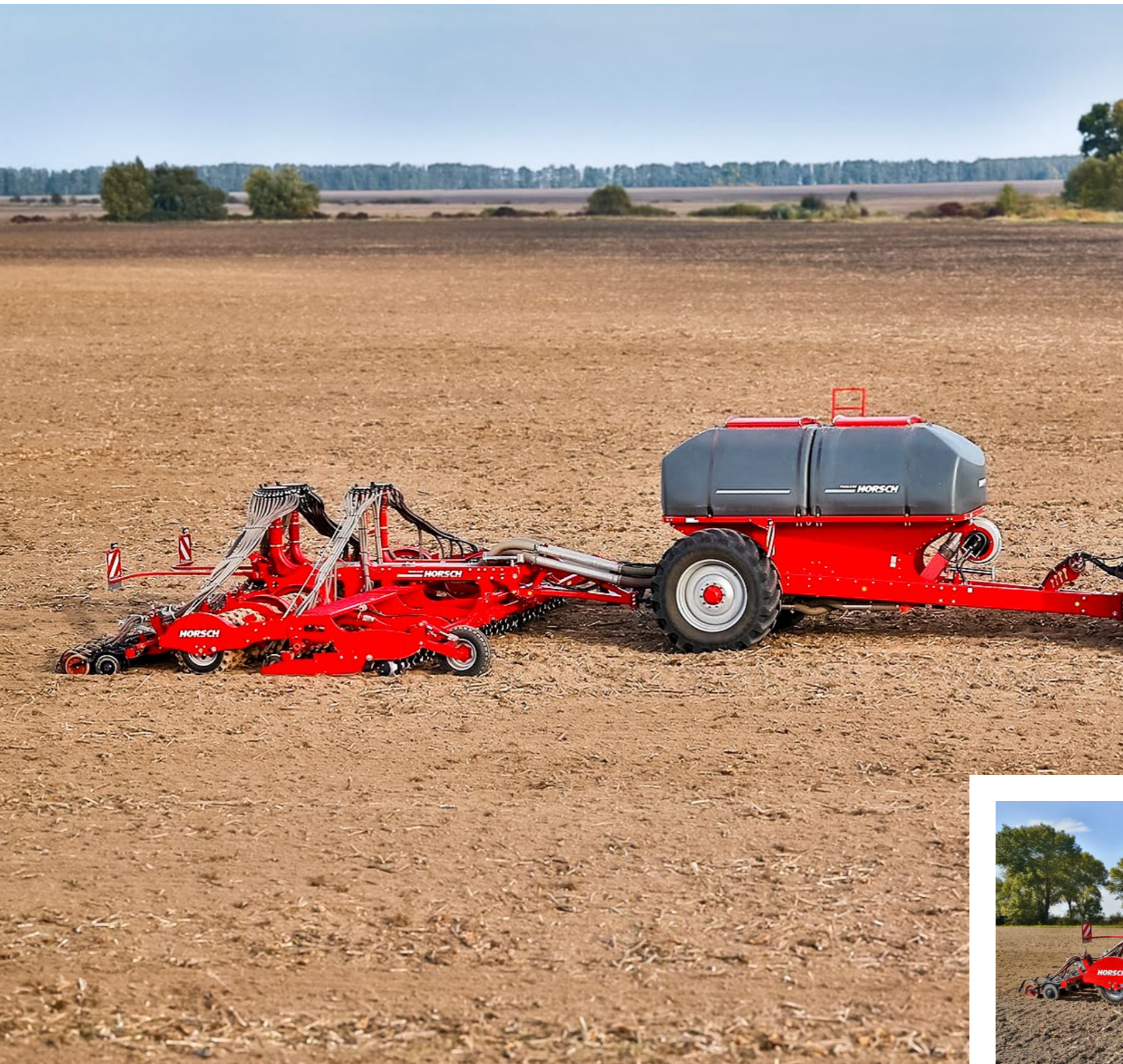
Сошник TurboDisc з високим притискним зусиллям для якісного висіву насіння
