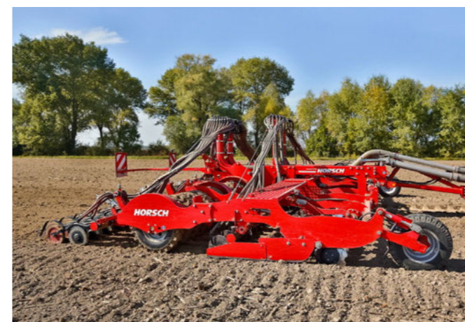
Сошник TurboDisc з високим притискним зусиллям для якісного висіву насіння
