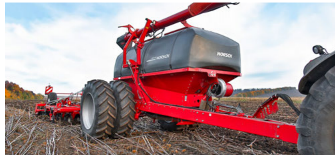
Двосекційний бункер з розподілом 6000:6000 л або трисекційний бункер з розподілом 4000:2000:6000 л
