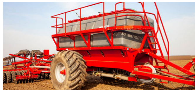
Двосекційний бункер з розподілом 8500:8500 л або трисекційний з розподілом 4000:6500:6500 л
