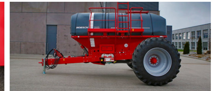
Можливість заповнення другої і третьої секції бункера двома додатковими компонентами, такими як гранульовані добрива та насіння
