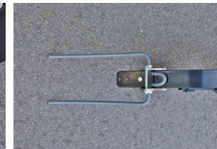
Штригельна борона з прямими зубами і насіннєвий сошник TurboDisc мають індивідуальне ведення за глибиною для ефективного обробки ґрунту
