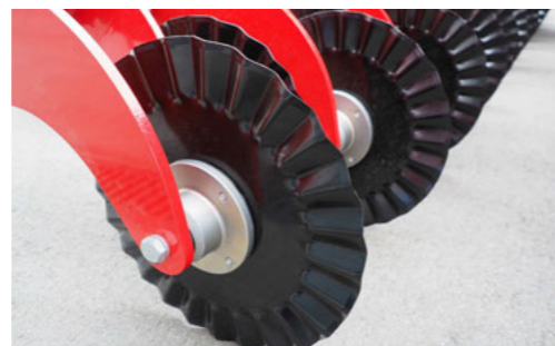
Рифлений диск 25-хвильовий Ø18" – ширина рифлення 20 мм - ідеально підходить для легких ґрунтів
