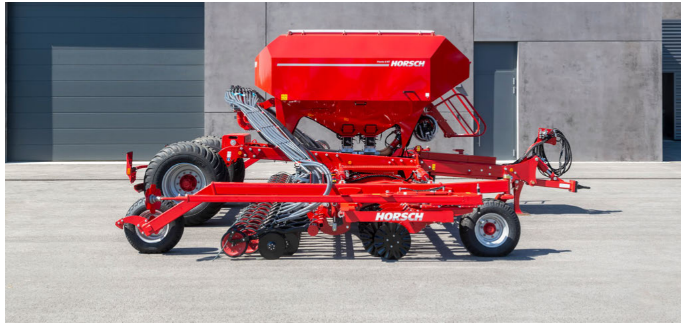
Pronto 9 NT з двосекційним бункером 5000 л
