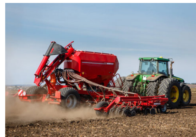
Гідравлічний завантажувальний шнек з продуктивністю до 800 кг/хв
