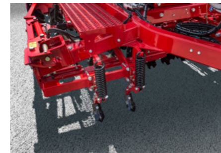
Підпружинені лапи для розпушування сліду трактора нівелюють ущільнення колії
