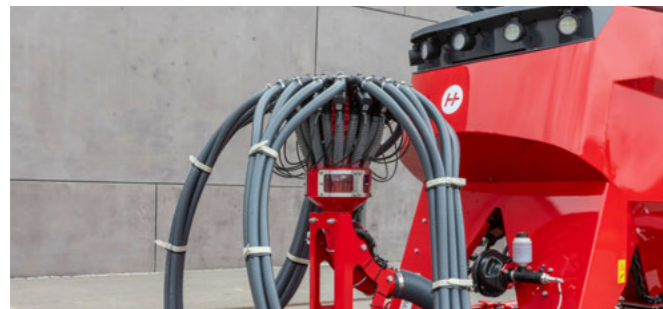
Pronto 3 DC з розподільною баштою RowControl
