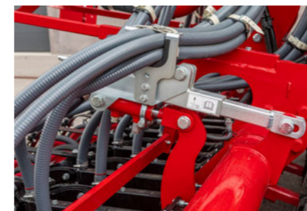
Притискне зусилля можна збільшити через гідравлічний вихід трактора
