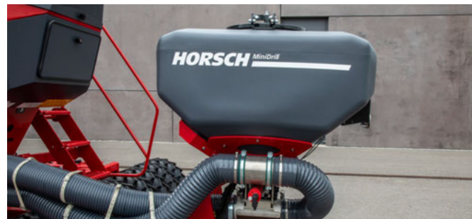
Pronto DC з MiniDrill у фронтальній частині
