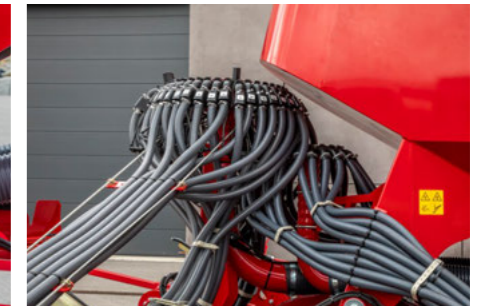
Розташована зовні розподільна башта системи PPF для оптимального доступу висівний сошник
