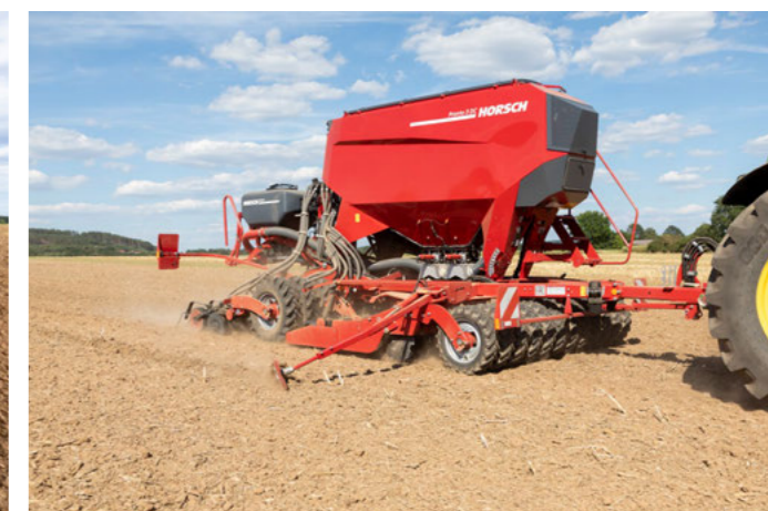
Опційний маркер колії для рівного стику між проходами
