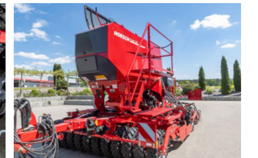
Бункер напірного типу з бічною платформою
