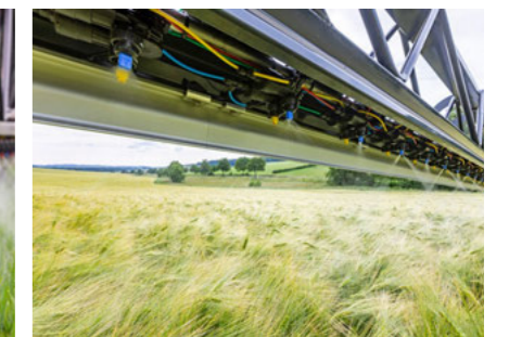
Пневматичне перемикання форсунок і секцій штанги
