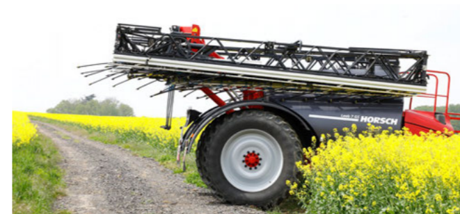
Система Connect & Fold – підходить для класичних аплікаторів Dropleg
