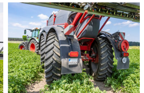
Активне керування обома осями з інтеграцією в програмне забезпечення машини
