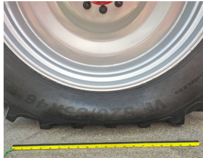
ATP Control — більша площа контакту із тиском у шинах 1,0 бар
