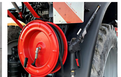
Мийка високого тиску з гідравлічним приводом
