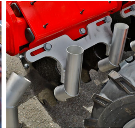
Виходи для рідкої органіки з неіржавної сталі для максимального строку експлуатації
