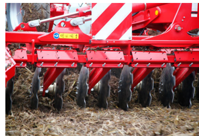
Великі і міцні підшипникові вузли для чіткого ведення дисків за глибиною
