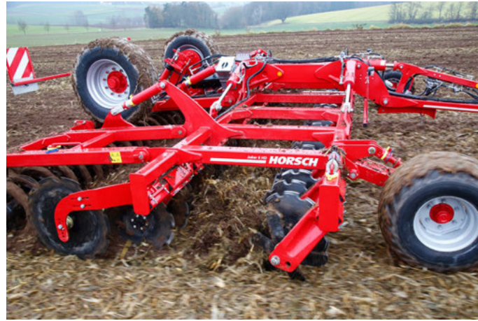
Велика відстань між дисками для максимальної прохідності машини
