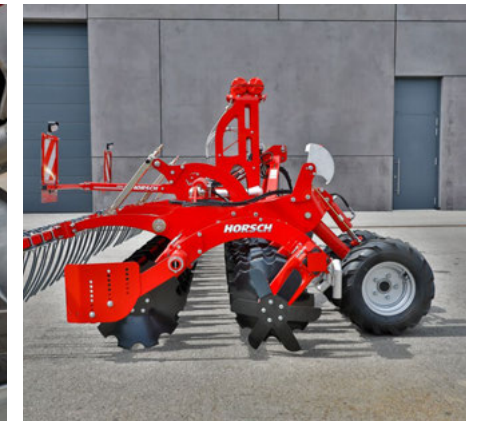
Варіант оснащення борони під комплект для рідкої органіки: без котка зі штригельною бороною для мінімізації забивання машини
