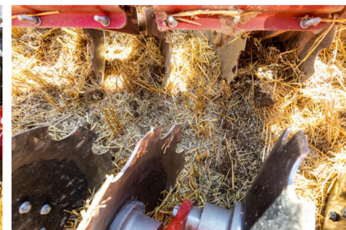
Попарне кріплення дисків для максимальної прохідності
