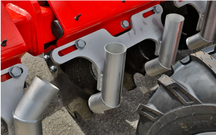
Трубчасті виходи для рідкої гноївки із неіржавної сталі для максимальної зносостійкості
