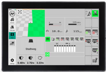
Виведення до 3-х віджетів паралельно з відображенням основного процесу дає змогу контролювати кілька функцій одночасно.
