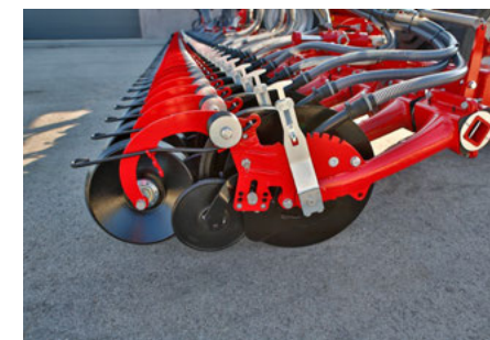
Ідеальне копіювання поверхні ґрунту сошником SingleDisc завдяки опорному колесу глибини
