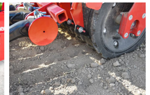
FarmFlex Packer Vermindert Verkrustung durch streifenweise Rückverfestigung
