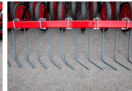
Gekröpfte Zinken sorgen für eine Querbewegung der Erde und verdecken so sicher jedes Saatkorn
