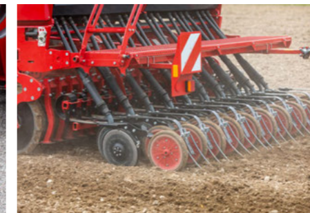
DuoDisc Säschar mit geradem Striegel
