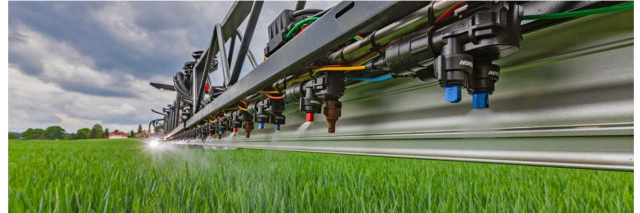
Die pneumatische Düsenschaltung und die pneumatische Teilbreitenschaltung erlauben es, punktgenau Düsen und Teilbreiten mit Druckluft an- und abzuschalten. Dabei stehen Düsenabstände von 25 cm und 50 cm zur Auswahl.
