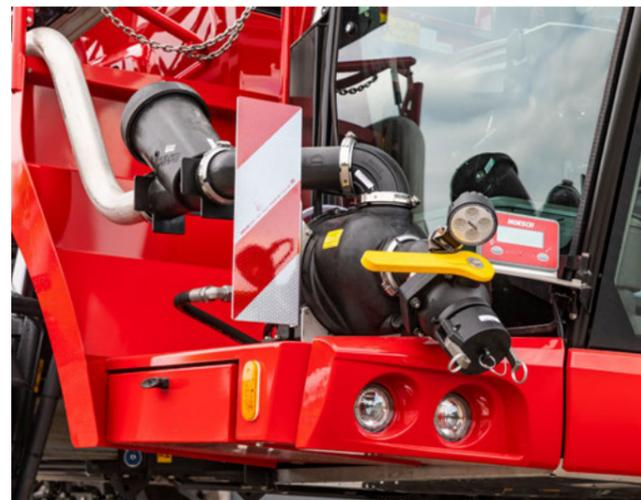
Powerfill Befüllpumpe mit 1 000 l/min Leistung - 3" Camlock Befüllanschluss vorne rechts
