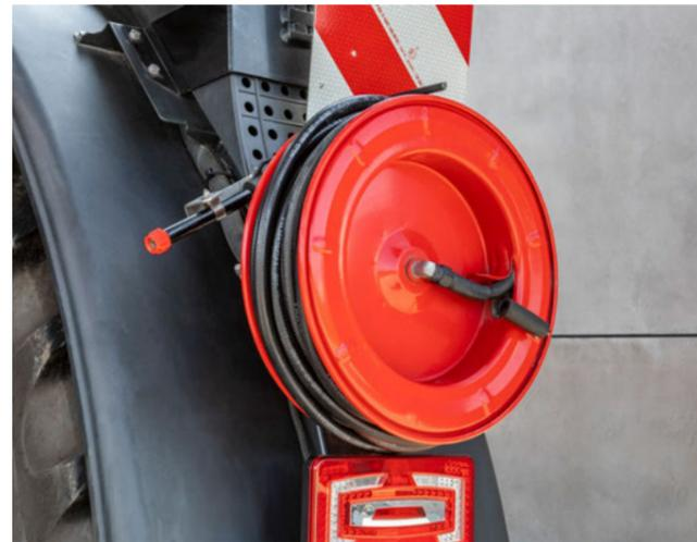
Schlauchtrommel zur Außenreinigung
