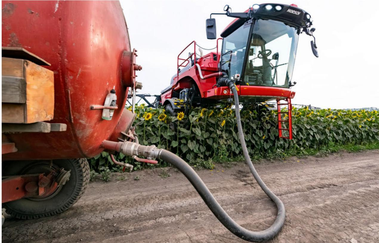
Befüllung auf dem Feld mit ausgeklapptem Gestänge
