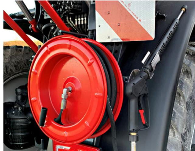
Hydraulisch betriebener Hochdruckreiniger
