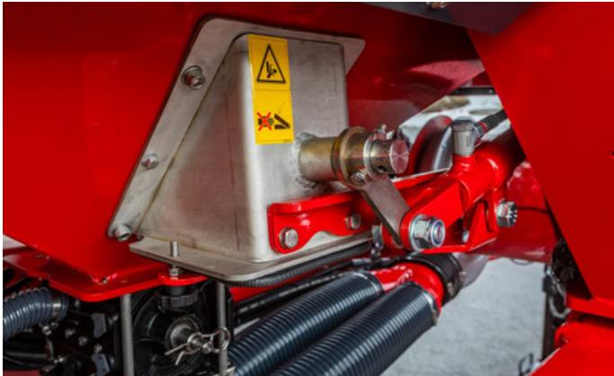
Boltozódásgátló a műtrágyatartály külsején
