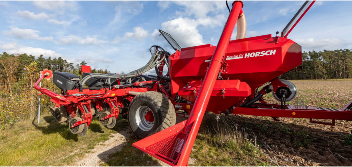
A feltöltőcsiga a Maestro DV mindkét műtrágyatartályához használható
