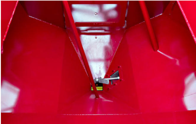
Boltozódásgátló a műtrágyatartály belsejében
