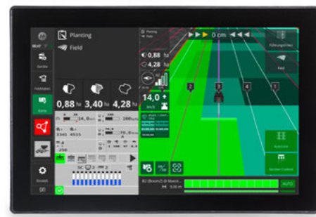
Az szemenkénti vetéstechnikával és a HORSCH AutoLine segítségével a művelőutak teljesen rugalmasan és a haladási iránytól függetlenül, GPS-támogatással vehetők
