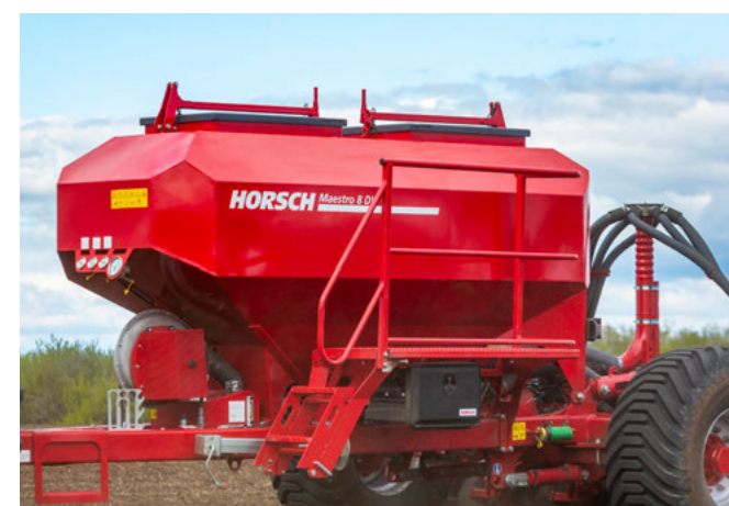
Duplatartály rendszer 3 500 l térfogattal
