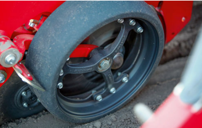
Küllős mélységtartó kerék: jobb öntisztulás, ezért ideális a fekete talajoknál
