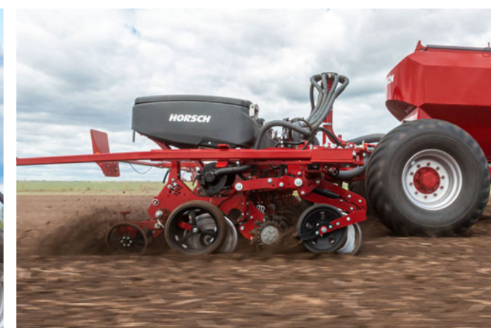
Egytárcsás műtrágyacsoroszlya, küllős mélységtartó kerék és ujjas nyomógörgő ideálisak a csernozjom talajokhoz
