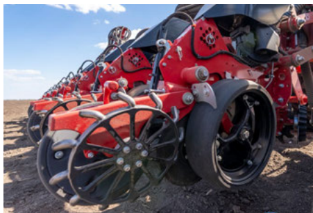
Kijuttatás közvetlenül a vetőbarázdába
