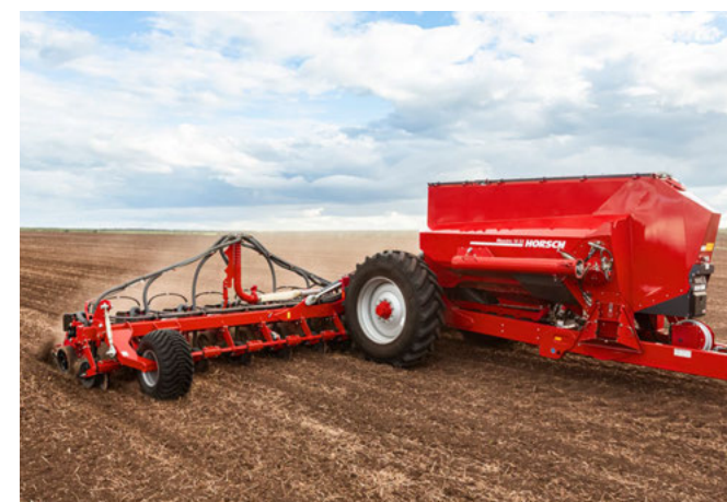
A széles gumibroncsok a sorok között futnak az eltolható tengelynek köszönhetően
