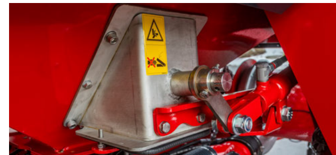
Boltozódásgátló a műtrágyatartály külsején
