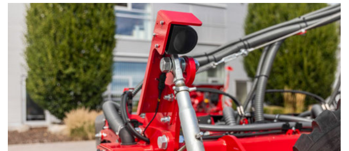
Egy további radarszenzor a ContourFarming számára
