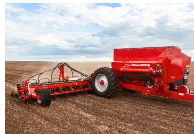
Szerokie opony poruszają się pomiędzy rzędami dzięki przesuwnej osi
