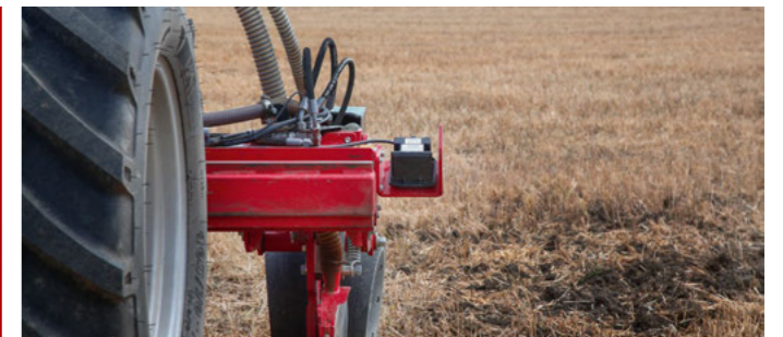
Jeden z dodatkowych czujników radarowych dla ContourFarming
