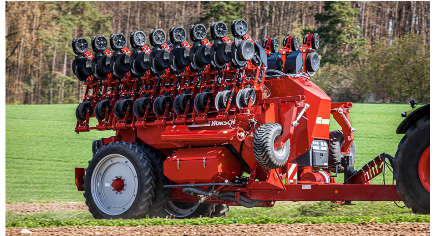
Kompaktowa konstrukcja transportowa o dużej pojemności zbiorników na nawóz i nasion
