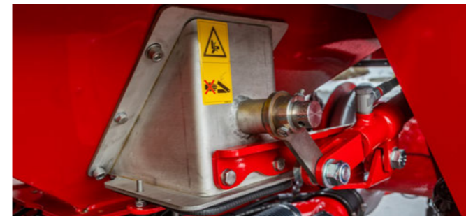
Walek mieszający w zbiorniku na nawozy od zewnątrz
