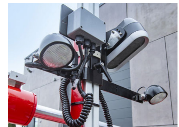
Система камер Culticam з опційним освітленням для роботи в сутінках або вночі
