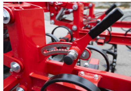
Широкий паралелограм з центральним регулюванням робочої глибини
