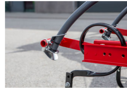
Розсівні пластини з опційним оснащенням MiniDrill, наприклад, для підсіву іншої культури
