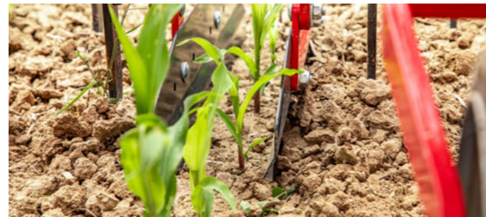
Захисні пластини під час обробітку поля кукурудзи
