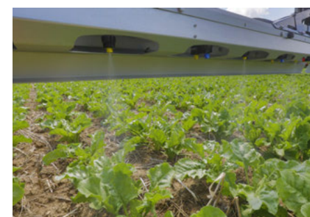
Стрічкове обприскування також не є проблемою з розміщенням корпусів кожні 25 см
