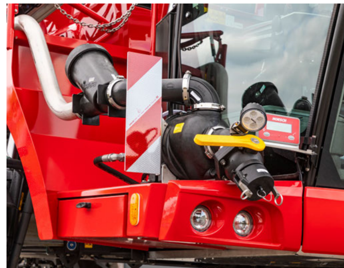
Насос для заправки Powerfill продуктивністю 1000 л/хв з клапаном заповнення 3" Samlock у передній частині машини праворуч
