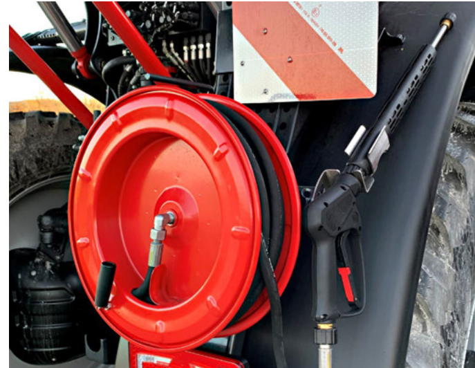
Мийка високого тиску з гідравлічним приводом
