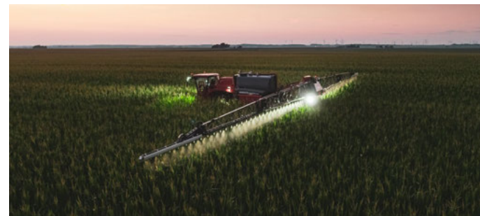
NightLight — освітлення конуса обприскування
