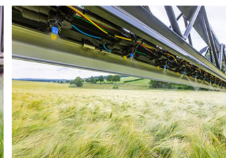
Пневматичне перемикання форсунок і секцій штанги
