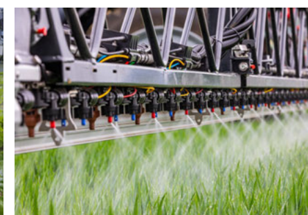
Розміщення корпусів форсунок кожні 25 см: більше форсунок — більше можливостей, наприклад аплікація у 3D-модусі
