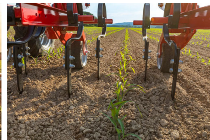
Надежная и точная обработка почвы вдоль рядов на различных стадиях роста растений
