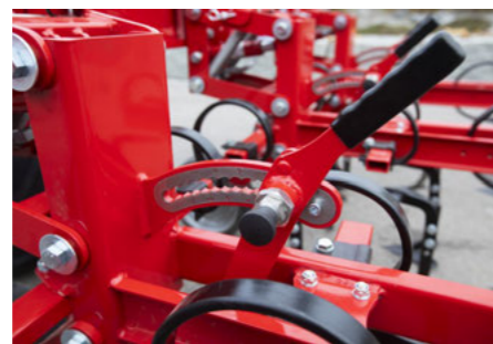
Широкий параллелограмм с центральной регулировкой рабочей глубины
