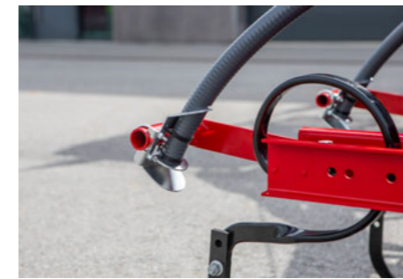
Дефлекторная пластина в комбинации с MiniDrill, например, для посева под покров
