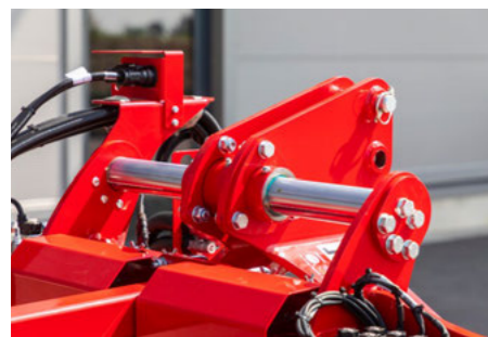
Прочная выдвигающаяся боковая консоль с ходом 450 мм
