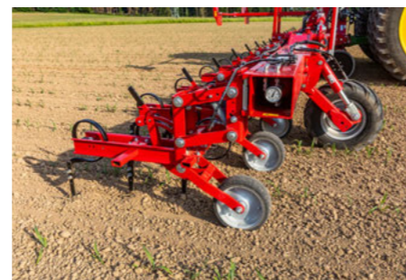
Прочная рама из квадратной трубы с встроенными креплениями-салазками
