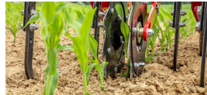
Защитные диски при обработке кукурузы
