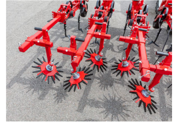
Пальчатые диски-пропольники обеспечивают обработку растений внутри рядов или рядом с ними, например, при выращивании кукурузы
