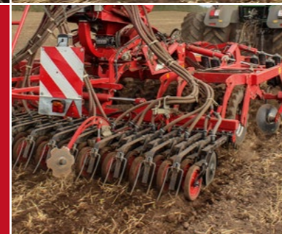
Rejas TurboDisc Distancia entre rejas de 15 cm, suspensión de rejas integrada, presión de rejas variable de hasta 120 kg/reja
