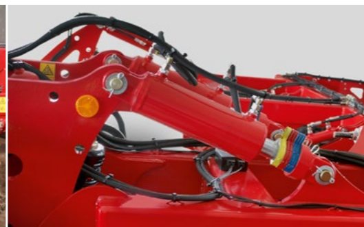
Ajuste de profundidad variable Con los espaciadores AluClip es fácil el ajuste de la profundidad de trabajo
