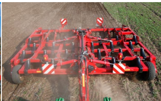
Protección de piedras Una protección mecánica de piedra bien probada, una protección hidráulica de piedra en las primeras filas de púas de arrastre está disponible como opción
