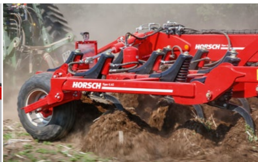
Cilindro hidráulico de la púa TerraGrip para fuerzas de liberación de hasta 770 kg (opcional para la primera y segunda fila de púas para el Tiger 5, 6, 8 AS)
