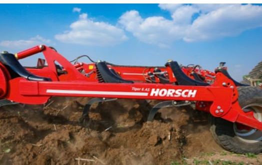
TerraGrip Mezcla intensiva y mullido del suelo con cuatro filas de brazos
