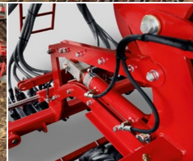
Pronto TD Ajuste variable de la profundidad de siembra con los espaciadores AluClip
