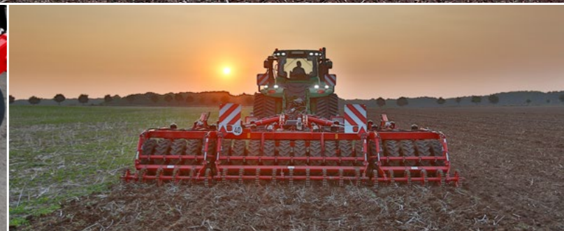
Consolidación: el compactador de neumáticos de gran capacidad de carga, la consolidación profunda y el compactador TopRing (disponible como opción) garantiza una excelente superficie de trabajo.
