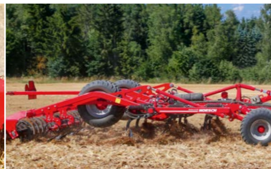
Construcción ordenada con chasis intermedio en la posición de trabajo
