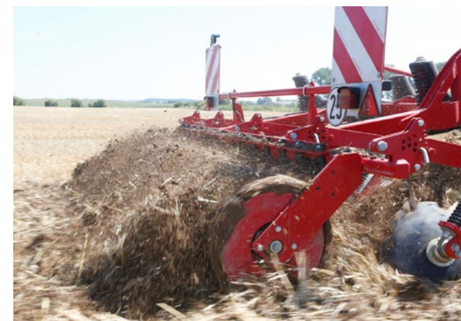
Alta producción de tierra fina por parte del rodillo para condiciones óptimas de germinación.
