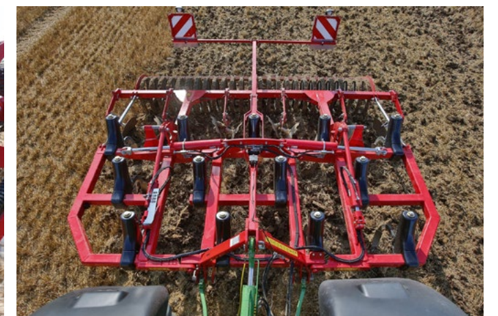
Distribución uniforme de púas para un buen flujo de tierra
