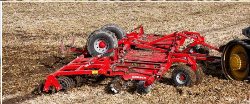
Opcional para Joker 5/6/8 RT regulación hidráulica de la profundidad de trabajo
