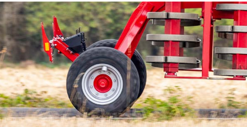
Chasis de transporte transporte seguro en carretera; sistema de frenos opcional
