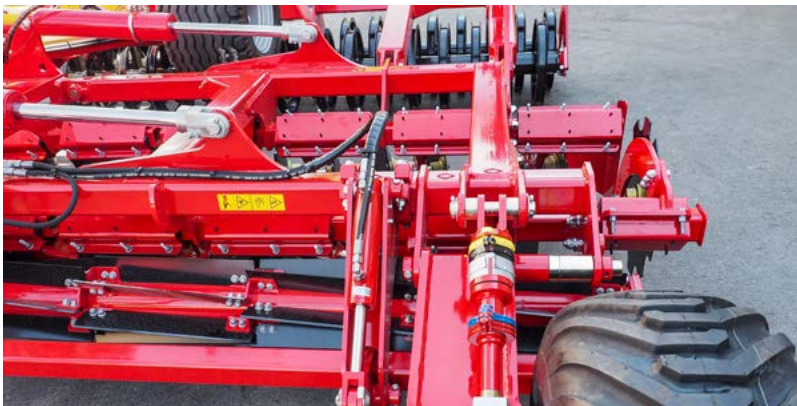
Ajuste de la profundidad de trabajo con clips (estándar)
