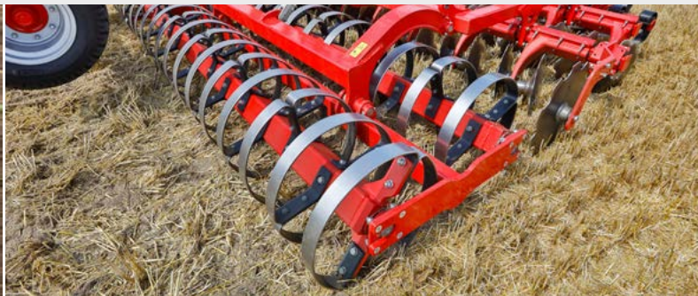
Compactador doble RingFlex – bajo requerimiento de caballos de fuerza y alta área de contacto
