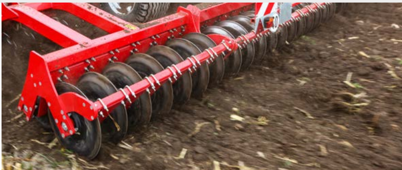
Compactador SteelDisc cerrado con anillos cortantes
