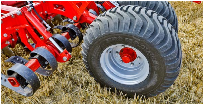
Ruedas de control de profundidad
