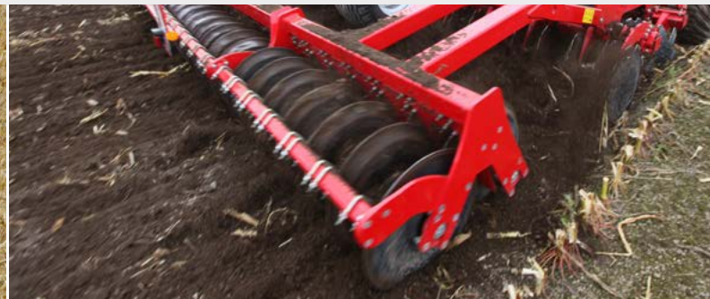
Compactador doble-SteelDisc para una consolidación óptima también en suelos muy pesados
