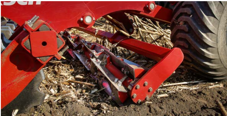
Compactador de cuchillas opcional para los Joker 5-8 RT
