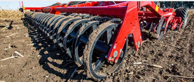
Compactador doble-RollPack para un buen desmenuzado y una buena consolidación del suelo
