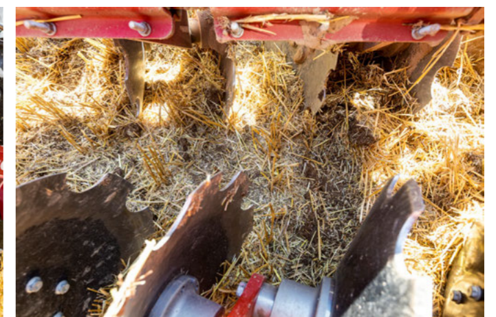
Disposición en pares de los discos para un paso máximo
