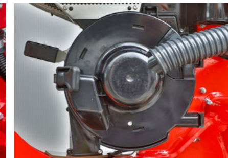
Gut zugänglicher AirVac Dosierer
