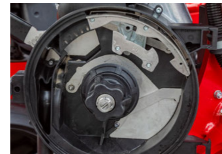
Der universelle Vereinzeler muss nicht mehr eingestellt werden
