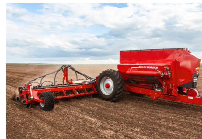
Die Breitreifen laufen dank der Verschiebeachse zwischen den Reihen
