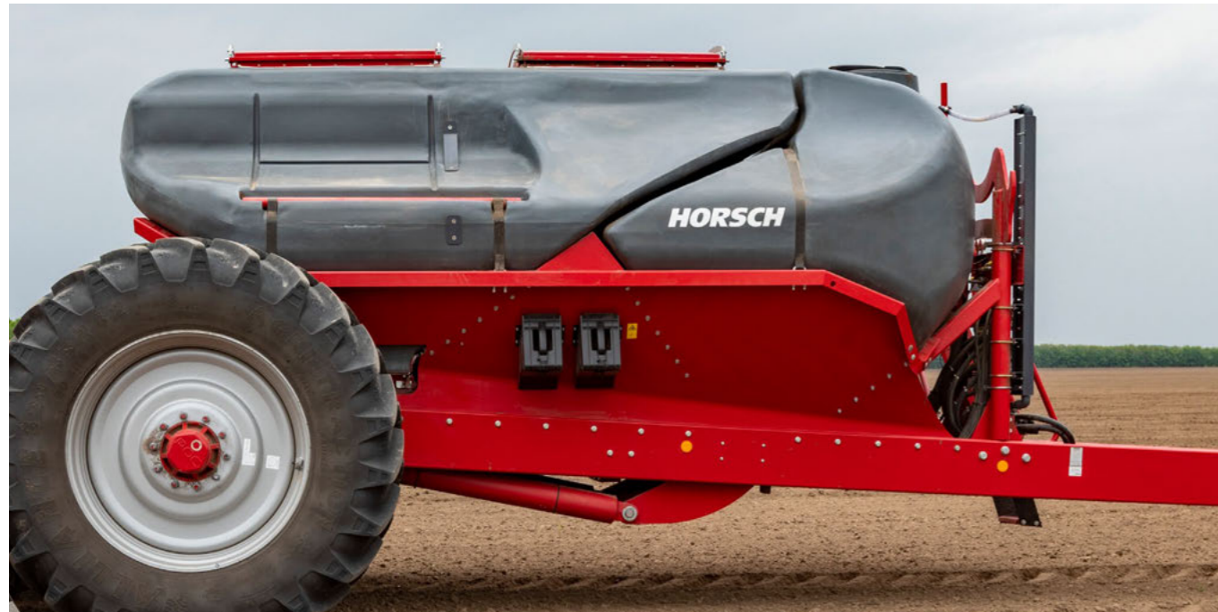
Flüssigdüngersystem bestehend aus Tank, Pumpe, Reihenüberwachung und sektionaler Reihenabschaltung
