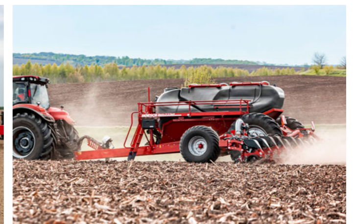
Gewichtsübertragung vom Säwagen auf die Särschiene für hohen Scharndruck bis 350 kg
