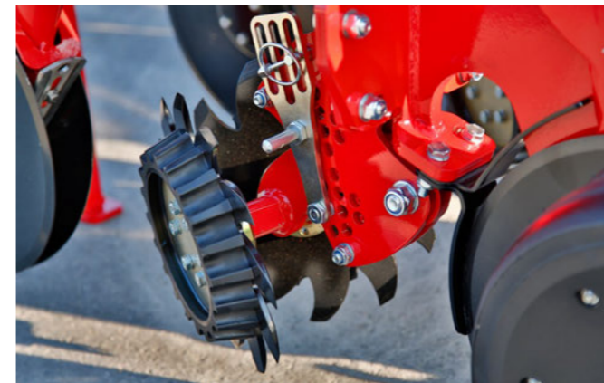
Optionale Räumsterne, schwimmend mit Tiefenführung
