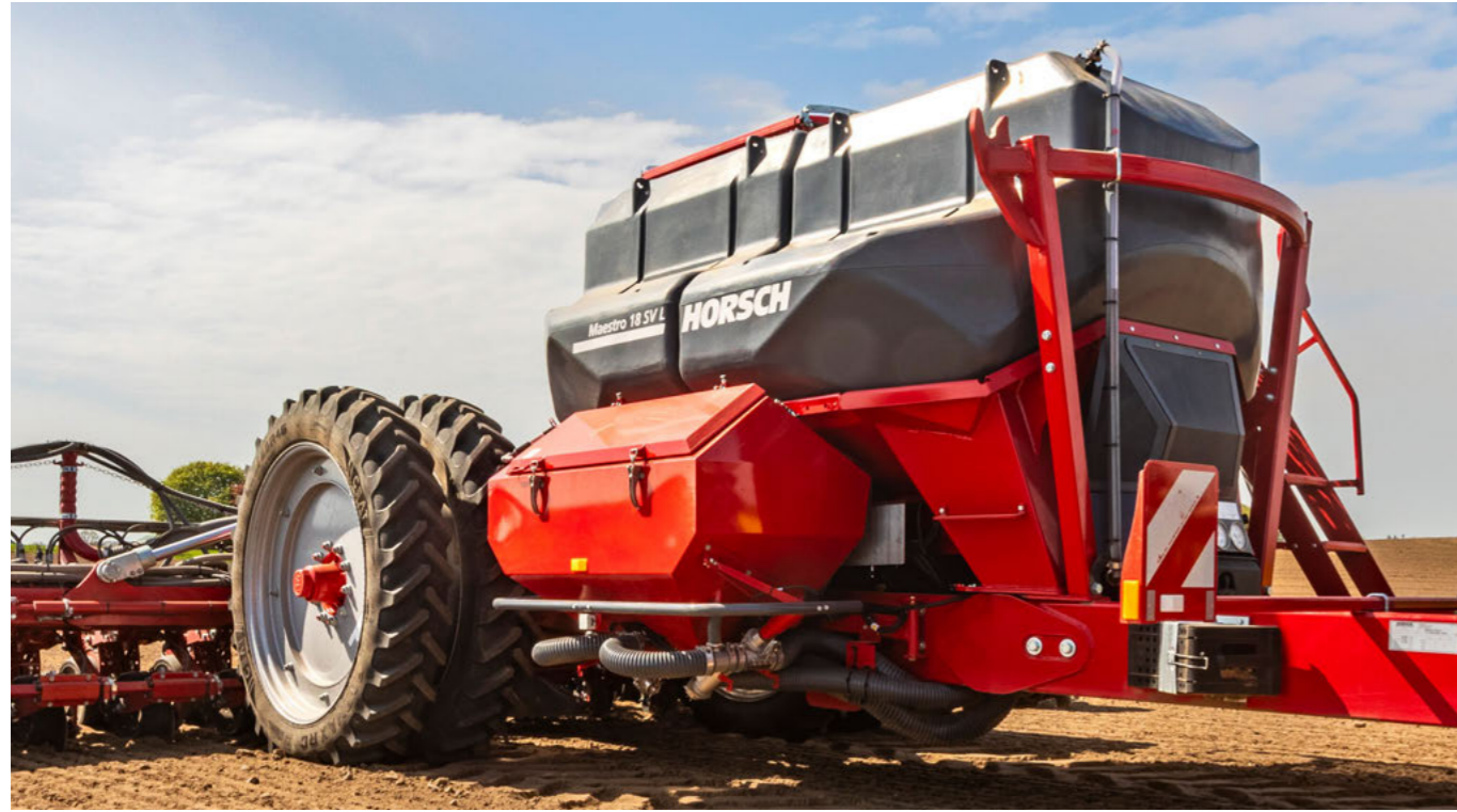
Mikrogranulateinheit Zur Befüllung und besseren Zugänglichkeit der Maschine kann der Tank nach vorne geschwenkt werden
