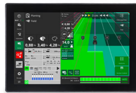
Mit Einzelkornsätechnik und HORSCH AutoLine lassen sich Fahrgassen gänzlich flexibel und unabhängig von der Anbaufrucht GPS-gestützt säen
