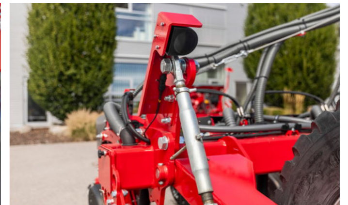
Einer der zusätzlichen Radarsensoren für ContourFarming
