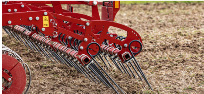
Herse double avec réglage hydraulique de l'agressivité
