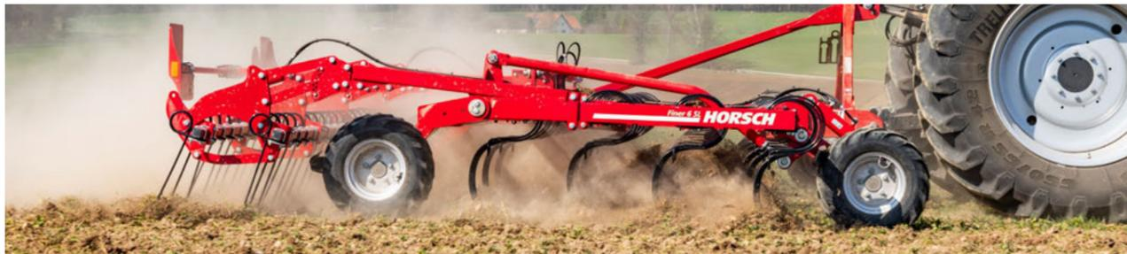
Quatre roues de support arrière avec support au niveau du rouleau
