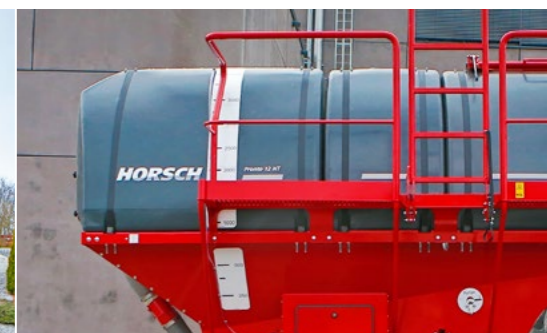
Хорошо видимая шкала уровня заполнения бака с жидким удобрением
