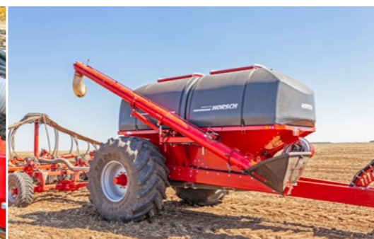
Гидравлический загрузочный шнек производительностью до 800 кг/мин
