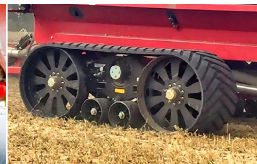
Оptionальные гусеничные движители с площадью опоры 4,2 м 2
