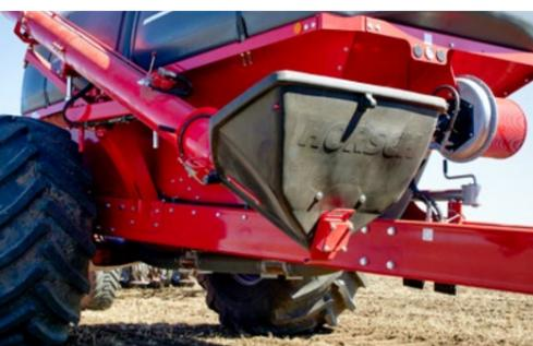
Großer Befülltrichter der optionalen hydraulischen Befüllschnecke
