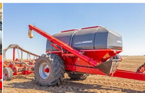
Hydraulische Befüllschnecke mit bis zu 800 kg/min Leistung
