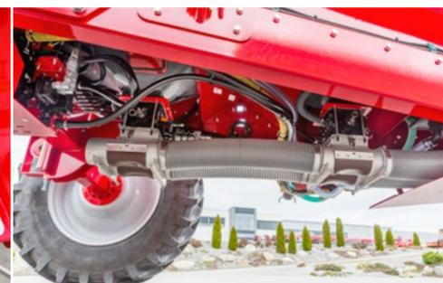
Leicht zugängliche Fallschleusen für schnelles Kalibrieren der Maschine
