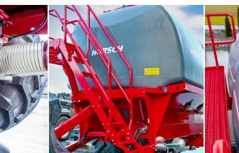
Sicheres Aufsteigen, dank Handlauf und großen Stufen
