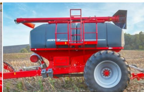
Großflächiges Podest mit komfortablem Zugang der einzelnen Tanks bei SW 12000
