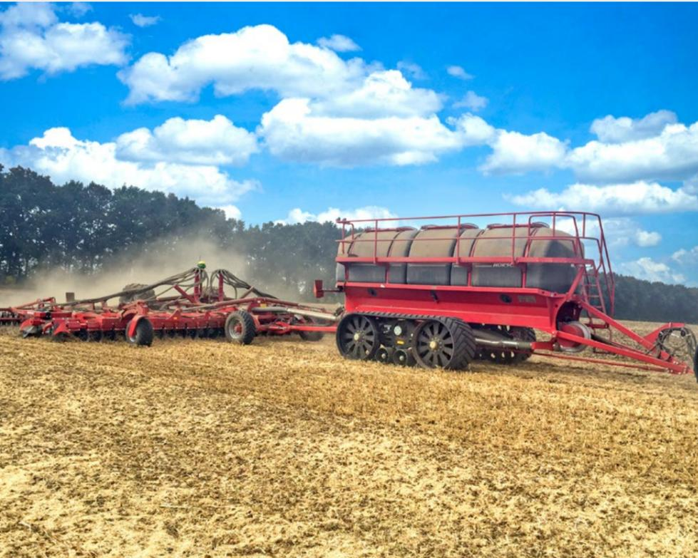
Für die Säwagen SW 12000, SW 12003 sowie SW 17003 bietet HORSCH optional eine **Flüssigdüngervariante** an.
