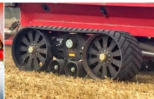
Optional erhältliches Raupenlaufwerk mit 4,2 m² Aufstandsfläche
