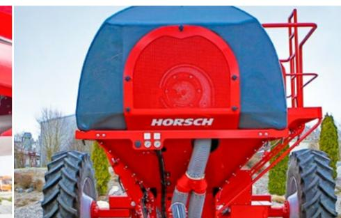
SW 12003 Flüssigdüngerversion mit integriertem hydraulischem Gebläse im Tank
