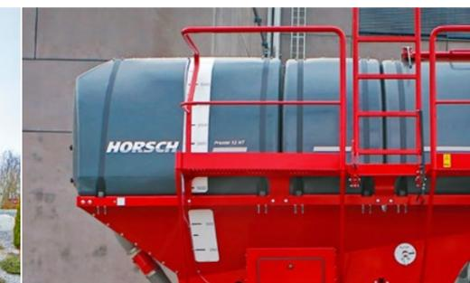
Seitliche, gut sichtbare Füllstandsanzeige des Flüssigdüngertanks
