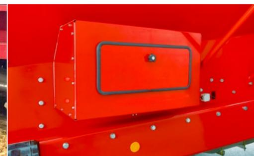
Verschließbare Werkzeugkiste für Dosierer, Abdrehsack und Abdrehwage sowie sonstiges Equipment
