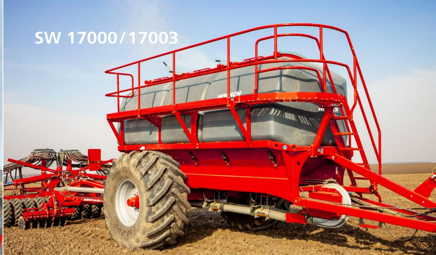
Die Säwagen **SW 17000** und **SW 17003** bestehen aus bewährten HORSCH Komponenten, wie die korrosionsbeständigen Kunststoff-tanks, einem ausgereiftem Pneumatiksystem mit Halbseitenabschaltung und der bekannten und sehr beliebten HORSCH Bedienoberfläche im Terminal.
