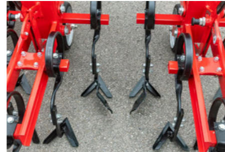
Blacha „obsypnika” w wersji lewo – i prawobrzeżnej
