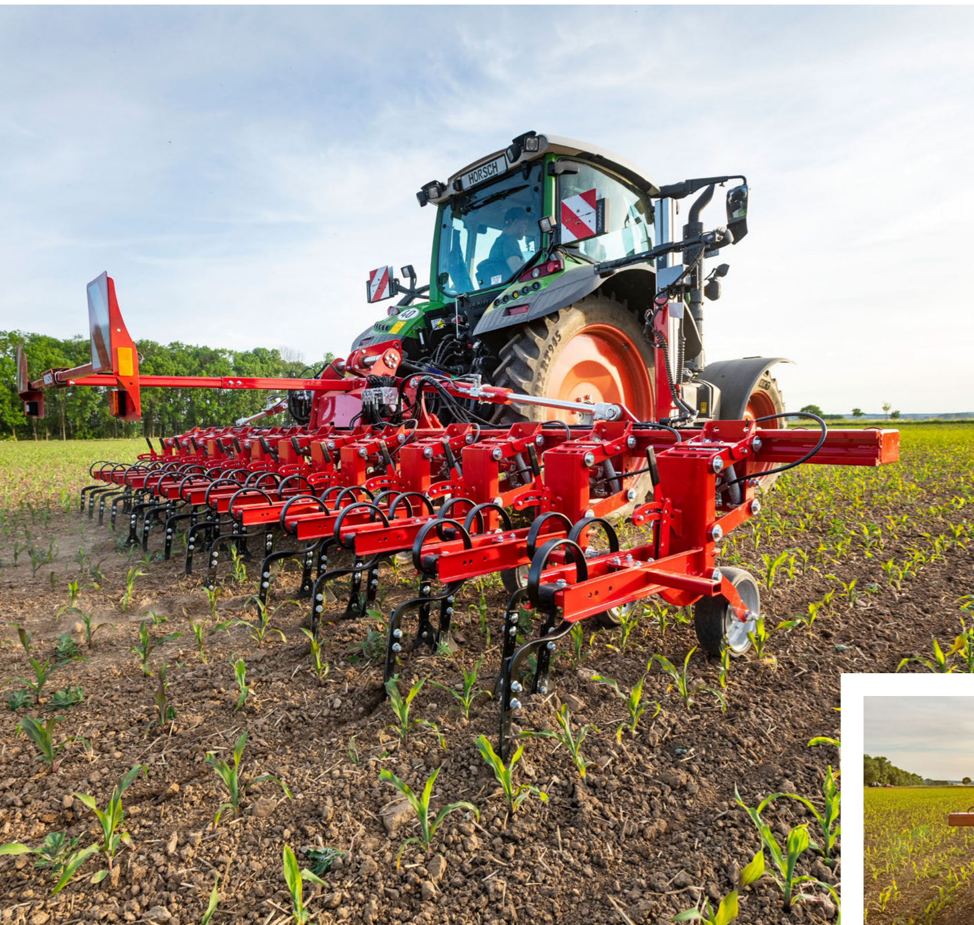
Bardzo precyzyjne sterowanie wzdłuż rzędów roślin za pomocą dostępnej opcjonalnie kamery Culticam
