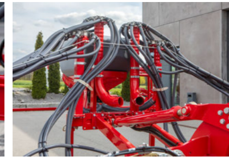
Transformer 9 VF z nabudowanym MiniDrillem oraz zestawem do nawozu
