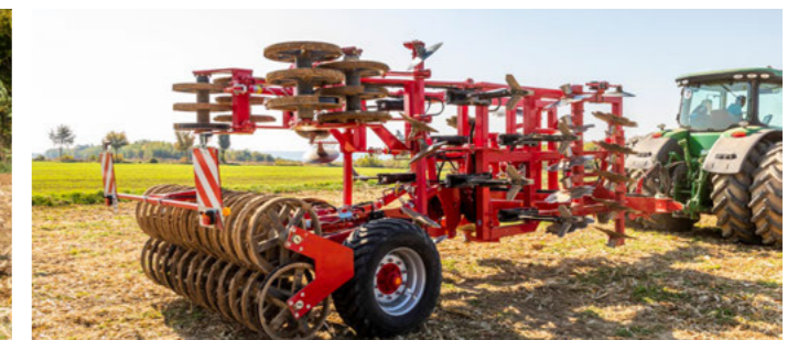
Pozycja transportowa z obrotowym podwoziem.
