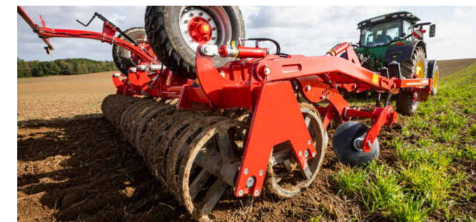
Podwójny wał RollPack z wahaczowym układem jezdny
