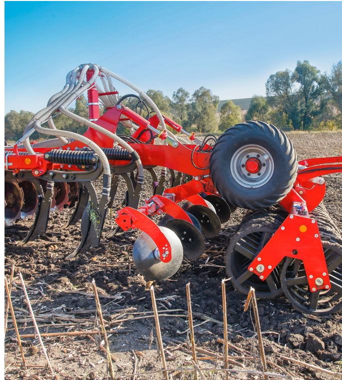
Głowica rozdzielacza nawozów w połączeniu z zasobnikiem Partner FT
