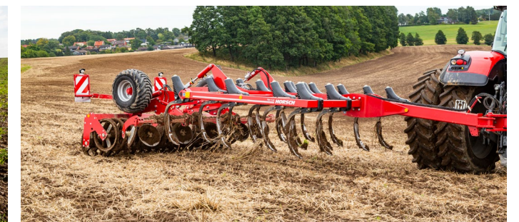
Tiger w wersji sztywnej z wahaczowym układem jezdny
