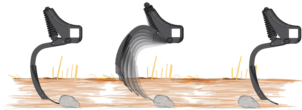
Ilustracja siły wyzwalającej w TerraGrip II
