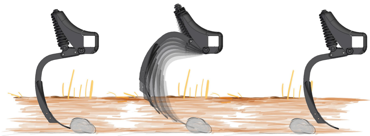
Ilustracja siły wyzwalającej w TerraGrip II
