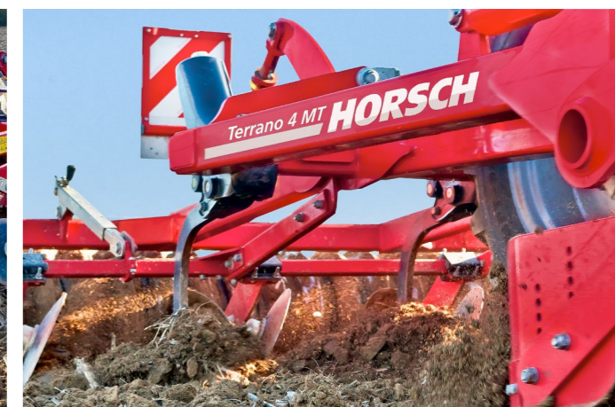
Głębokie spulchnianie i minimalne mieszanie dzięki redlicom LD
