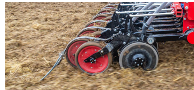
Możliwy nacisk na pojedynczą redlicę: do 200 kg
