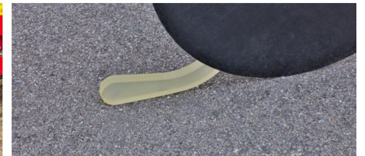
Wąs dociskowy HORSCH zapewnia precyzyjne unieruchomienie materiału siewnego
