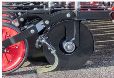
Rura spadowa ustawiona jest przed piastą koła, a ruchomy, wewnętrzny skrobak zapobiega zapychaniu się redlic w wilgotnych warunkach siewu
