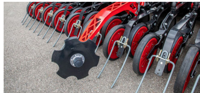
Agresywność znacznika przedwschodowego ustawia się za pomocą ogranicznika głębokości
