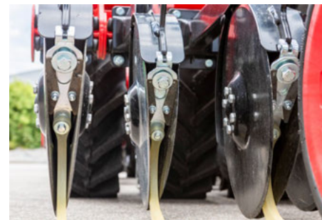
Ruchomy skrobak gwarantuje wysoki poziom samooczyszczania w mokrych warunkach
