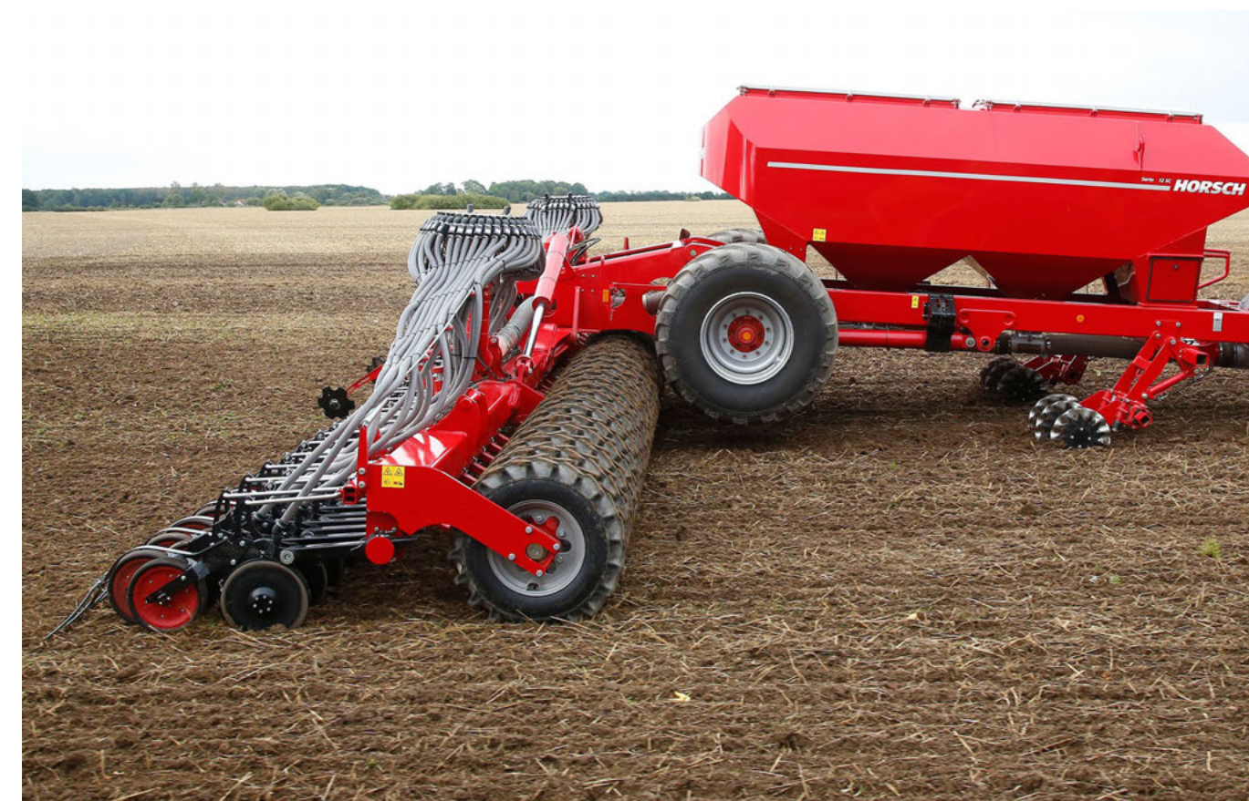
Spulchnianie zagęszczeń w śladzie ciągnika
