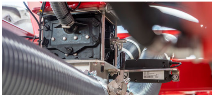
Możliwość automatycznego wyłączania połowy szerokości roboczej przez uaktywnienie SectionControl
