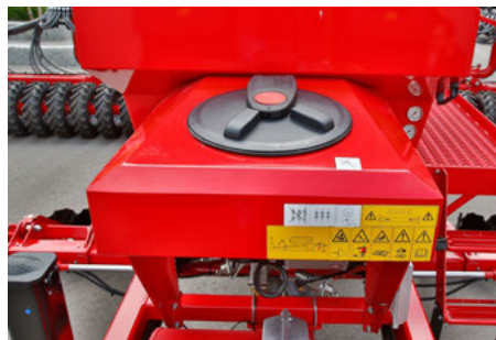
Element dozujący mikrogranulaty umożliwia równoczesne i niezależne dozowanie trzech komponentów
