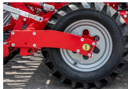
Łatwy w uciągu dzięki dużej średnicy opon oraz rezygnacji ze skrobaków
