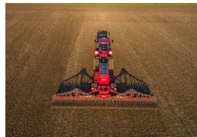
Pewne utrzymanie ustawionej głębokości siewu na całej szerokości roboczej dzięki hydraulicznemu przenoszeniu ciężaru wozu siewnego na skrzydła szyny siewnej
