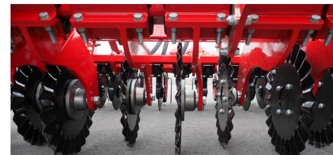
Spulchnianie powierzchni i tworzenie wystarczająco dużo drobnogruzelkowej gleby, aby zapewnić optymalne otulenie nasion ziemią
