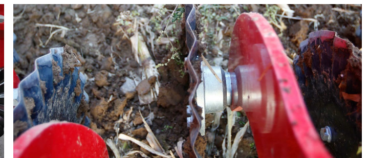
Usuwanie resztek poźniwnych i materiału roślinnego z pasów siewnych
