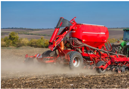
Łatwe napełnienie dzięki hydraulicznemu ślimakowi do napełniania
