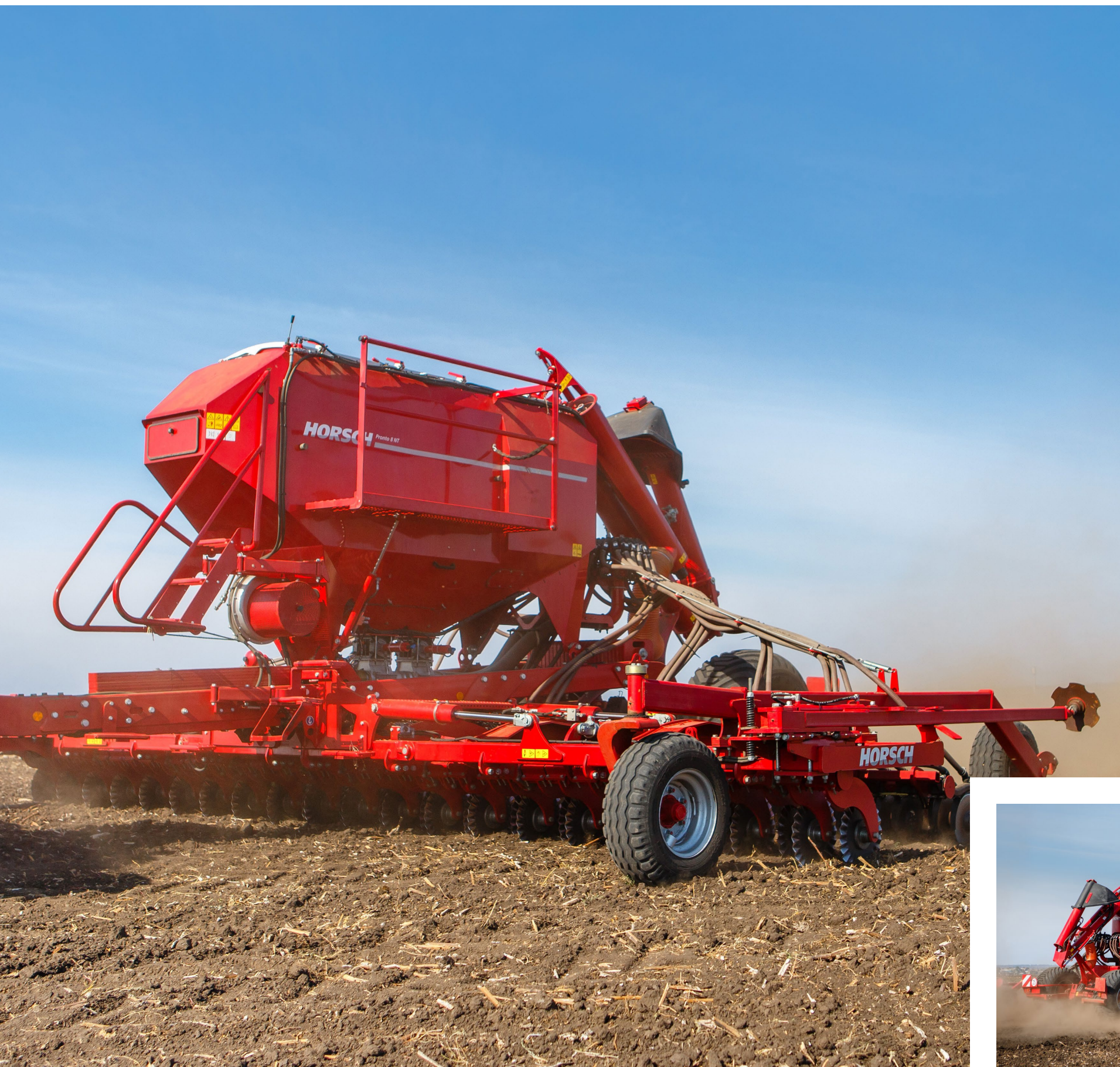
Hydrauliczny ślimak załadowczy o wydajności do 800 kg/min
