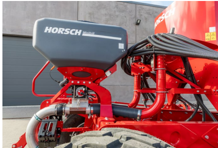
400 litrów rzepaku w MiniDrill umożliwia napełnienie pozostałych zbiorników nawozem mineralnym.
