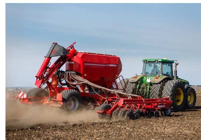
Hydrauliczny ślimak załadowczy o wydajności do 800 kg/min
