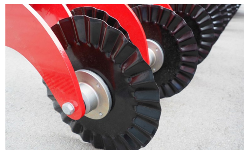
Tarcza falista 25-krotnie falowana Ø18” – szerokość jednego falowania wynosi 20 mm – zalecana do gleb lekkich
