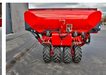
Szeroka na 1,3 m powierzchnia styku wszystkich 4 opon oraz dodatkowe obciążniki
