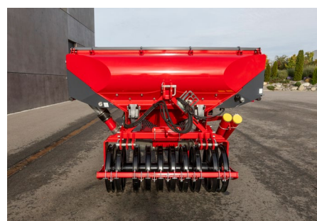
Wał RollPack zapewnia głębokie i pasowe wtórne zagęszczenie
