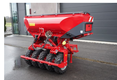
Wał oponowy gwarantuje równomierne wtórne zagęszczenie w niejednorodnych warunkach.
