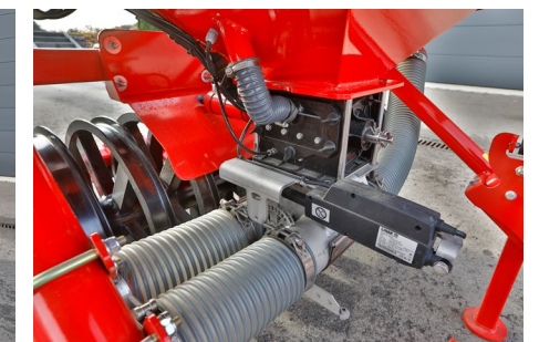
Partner 1600 FT z elektrycznym wyłączaniem połowy szerokości roboczej
