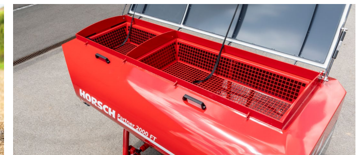
Partner 2000 FT z podziałem 75 : 25; duży zbiornik na nasiona lub granulowany nawóz oraz dodatkowo 550 l na mikrogranulat
