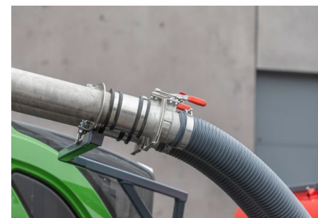
Szybkozłącza ułatwiają szybkie złączenie i rozprzęgnięcie między zbiornikiem przednim, konsolą ciągnika a narzędziem uprawowym
