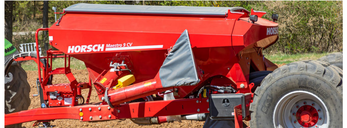
Złożony, hydrauliczny ślimak do napełniania zbiornika na nawozy
