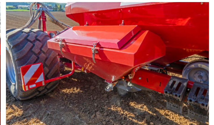
Centralna jednostka na mikrogranulatach o pojemności 300 l
