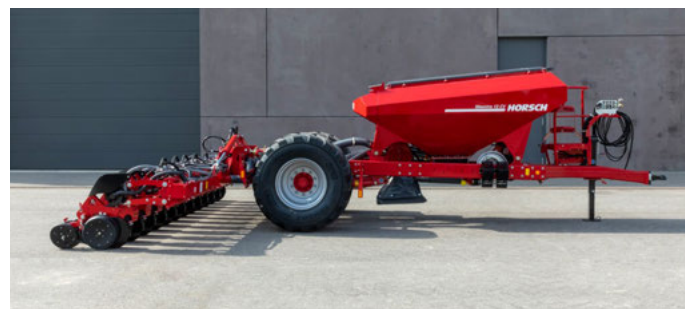
Wariant "seed-only" (tylko wysiew nasion) ze zbiornikiem nasiennym o pojemności 3000 litrów
