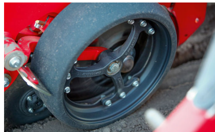
Szprychowe koła prowadzące na głębokości: Lepsze samooczyszczanie, dzięki czemu jest idealny dla czarnoziemu
