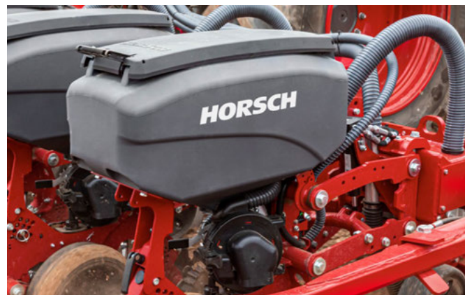
Pojemniki sekcji wysiewającej o pojemności 70 l
