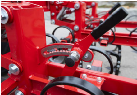
Široký paralelogram s centrálním nastavením hloubky
