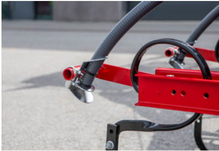
Lišta s odrazovými plechy v kombinaci s MiniDrill např. pro podsev
