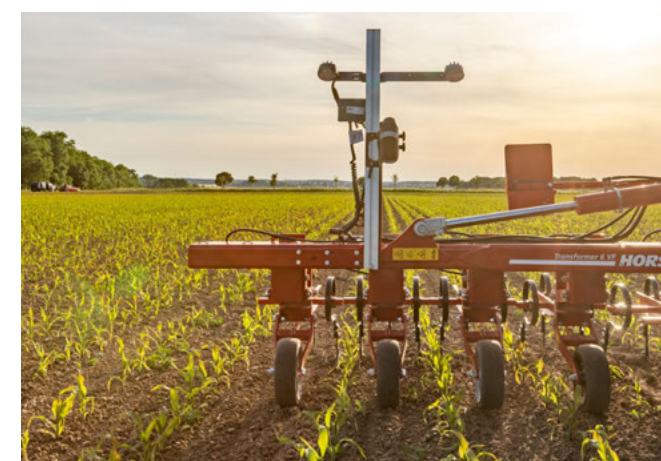
Vysoce přesné návádění podle řádků rostlin pomocí volitelné kamery Culticam
