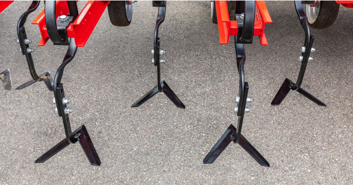
Paralelogramové zavěšení pro rozteč řádků 25 cm
