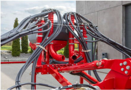
Transformátor 9 VF s MiniDrill a sadou na rozvod hnojiva
