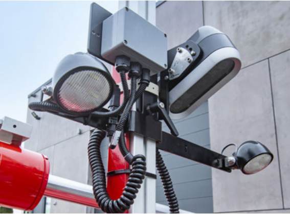
Ovládání navádění s kamerou Culticam s volitelným světelným balíčkem pro práci za soumraku nebo tmy
