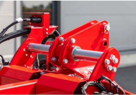
Robustní posuvný rám s posuvem 450 mm
