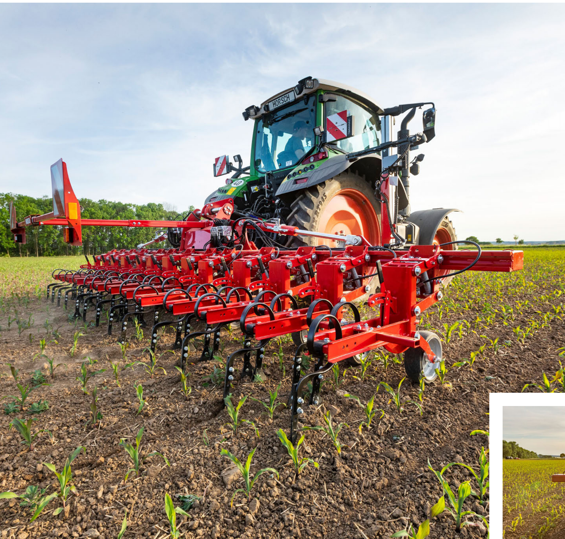
Vysoce přesné návádění podle řádků rostlin pomocí volitelné kamery Culticam
