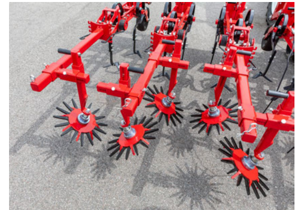
Prstová kola umožňují cílenou práci v řádku rostlin např. u kukuřice
