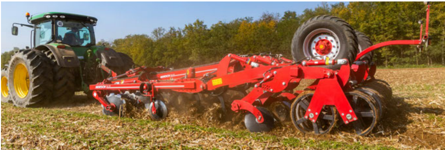
Intenzivní zpracování půdy pomocí talířů a radliček
