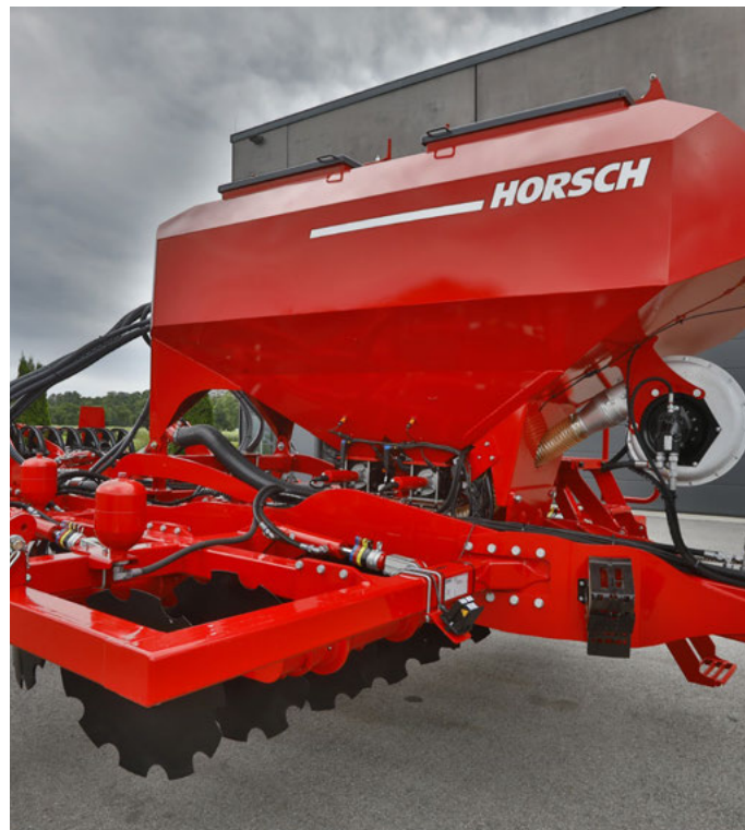
FertiProf s objemem zásobníku 2 800 l pro přímé hnojení v jednom přejezdu
