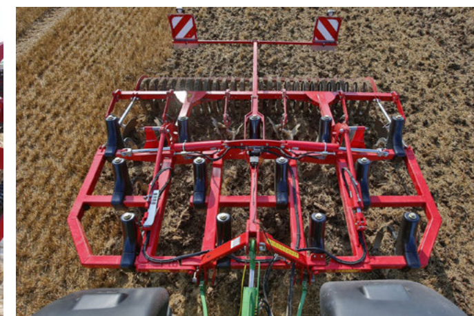
Rovnoměrné rozmístění slupic pro ideální tok materiálu
