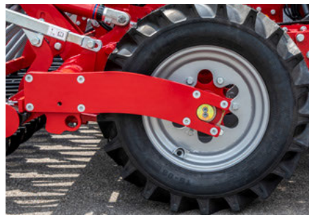
Nízké nároky na tažný výkon díky velkému průměru pneumatik a absenci stěrek
