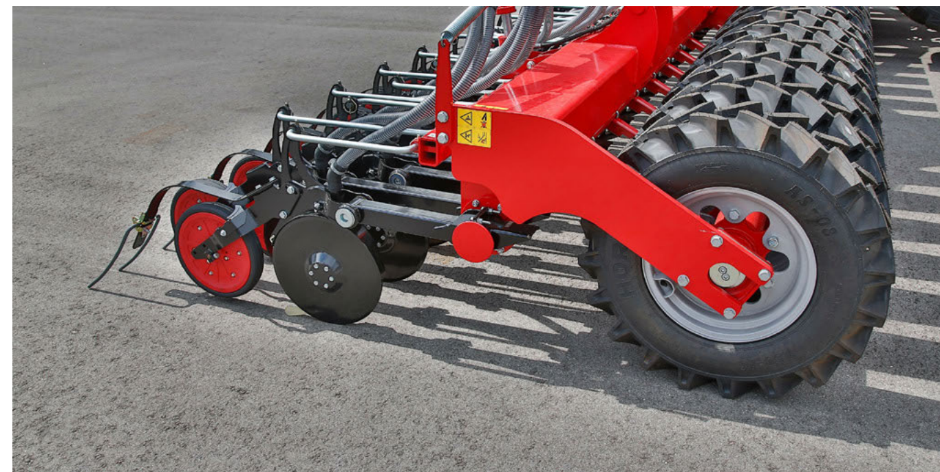
Secí botka PowerDisc – paralelogramem vedená dvoukotoučová botka
