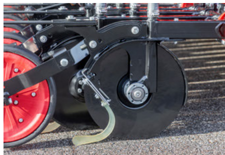
Pozice výpadu osiva před ložisky a pohyblivá vnitřní stěrka zabraňují ucpání botek při setí za vlhkých podmínek
