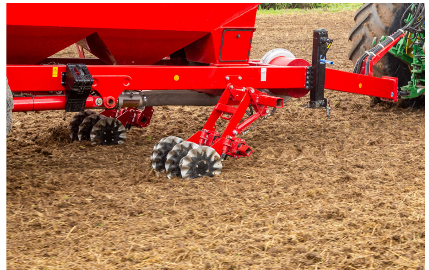
Narušení půdního zhutnění v kolejích traktoru
