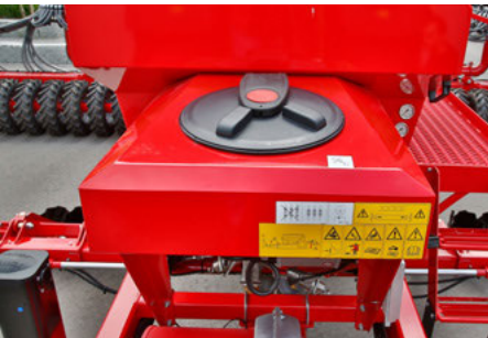
Zařízení pro dávkování mikrogranulátu nabízí možnost současně aplikovat tři komponenty a nezávisle je dávkovat.
