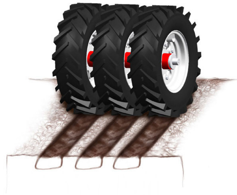
Cílené a rovnoměrné vyrovnaní a zpětné utužení před každou secí botkou
