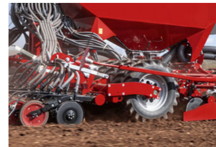
Účinné utužení pod seťovým lůžkem pro optimální vzlínání vody k osivu
