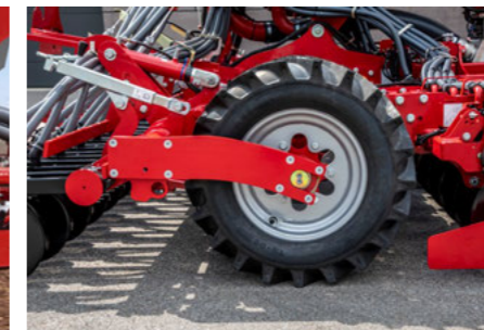
Nízké nároky na tažný výkon, díky velkému průměru pneumatik a absenci stěrek
