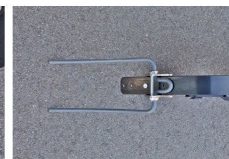
Rovný zavláčovač – zavláčovač secí botky TurboDisc je individuálně vedený spolu se secí botkou pro efektivní práci
