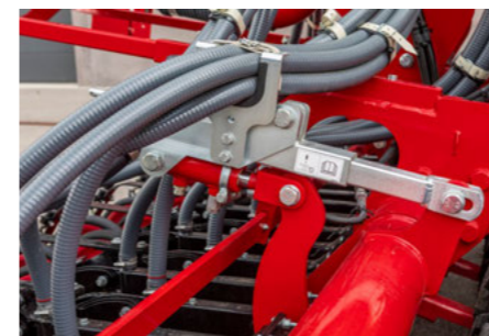
Přítlak na botku lze zvýšit pomocí řídicí jednotky na traktoru
