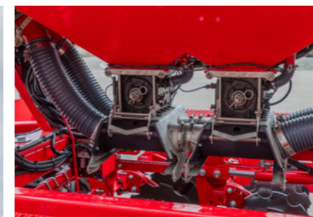
Dvoukomorový zásobník G&F – oddělené dávkování různých komponent a společné ukládání přes sečí lištu
