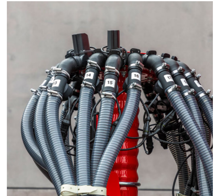
Kontrola průtoku hnojiva a osiva – pro bezchybné sledování průchodnosti hadic osiva a hnojiva
