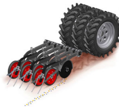
Dvoukomorový zásobník Grain & Fertiliser – společný výsev dvou komponent přes sečí botku TurboDisc
