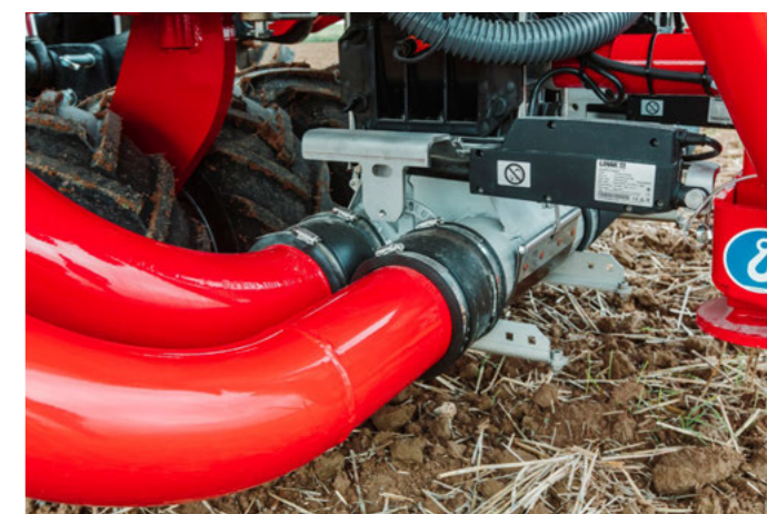
Elektrické vypínání poloviny záběru- jednoduché zapnutí a vypnutí poloviny záběru stisknutím tlačítka na terminálu
