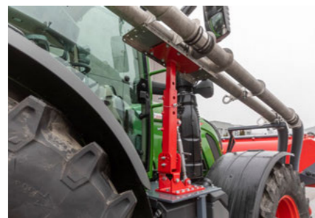
Stabilní a bezpečné rameno pro montáž pneumatických komponentů stroje Partner FT
