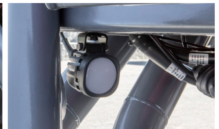
Osvětlení dávkovací jednotky pro pohodlnou kalibraci
