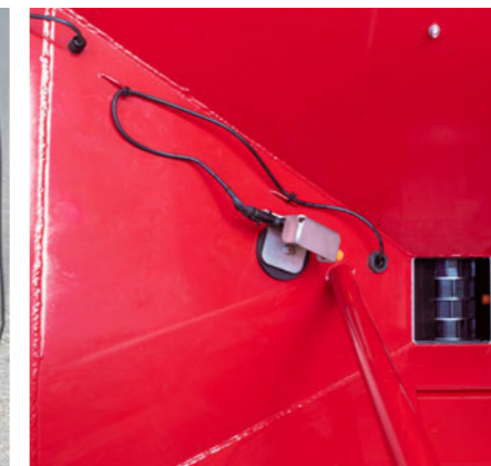
Dva senzory nízké hladiny – jeden výškově nastavitelný v zásobníku a jeden přímo na dávkovacím zařízení
