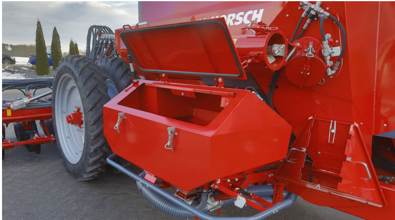
Aplikátor mikrogranulátu Pro plnění a lepší přístupnost lze nádrž vykloupat dopředu.
