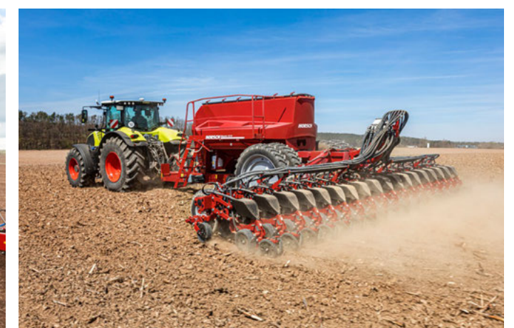
Maestro 18 SV s 5 400 l zásobníkem hnojiva a 2 200 l zásobníkem osiva
