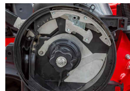
Univerzální jednotící stěrka již není třeba nastavovat
