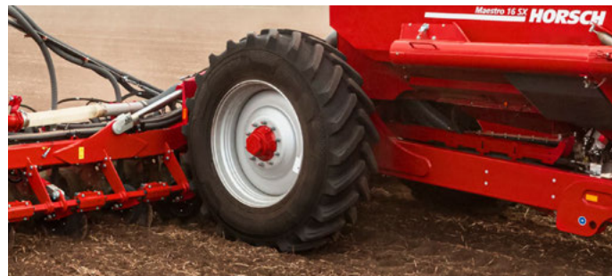
Široké pneumatiky běží díky posuvné ose mezi řádky
