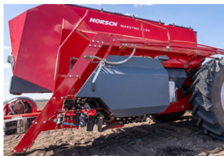
CLT systém s kapacitou nádrže 800 litrů
