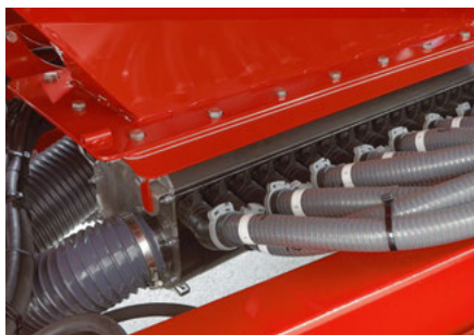
MTS rozvodná skříň
