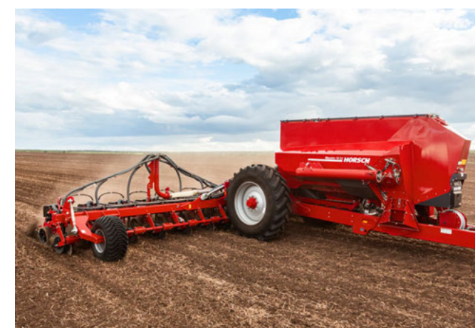
Široké pneumatiky běží díky posuvné ose mezi řádky
